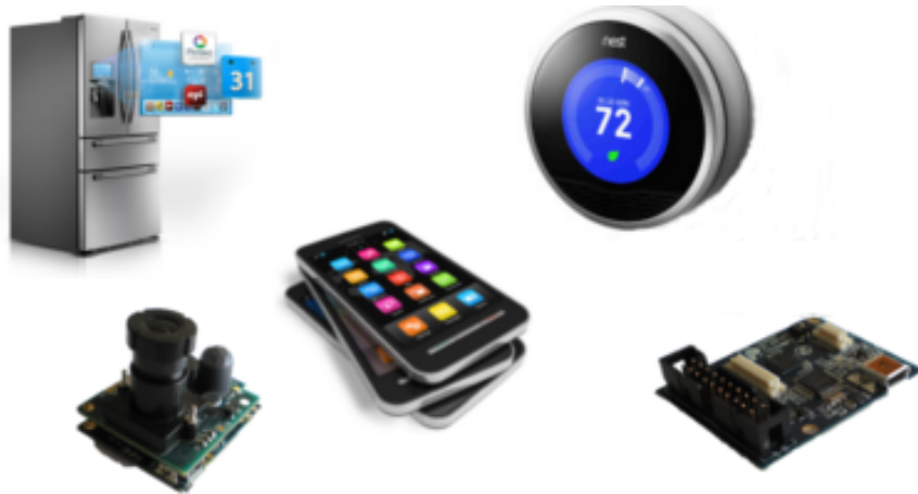
FIGURE 2.3 Quelques objets intelligents mis en œuvre dans l'Internet des objets. Des capteurs et effecteurs, en passant par un smartphone, un réfrigérateur connecté, et le Nest (objet emblématique de l'IoT), thermostat communicant.
