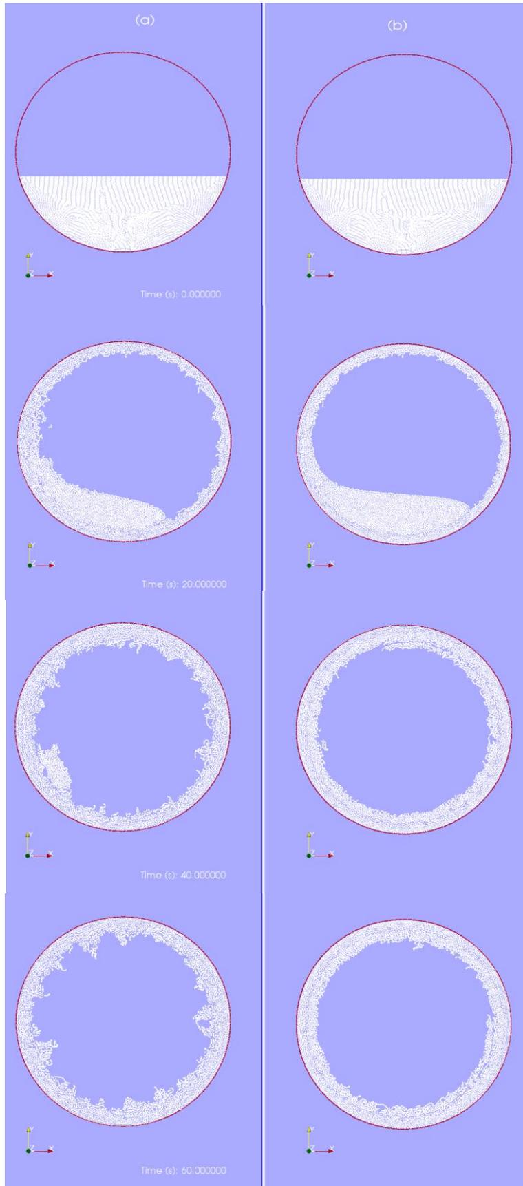
**Figure 75:** Simulation d'une fabrication d'une pièce cylindrique en 2D par rotomoulage réactif (a) : sans effets de tension de surface (b) avec force de tension de surface.
