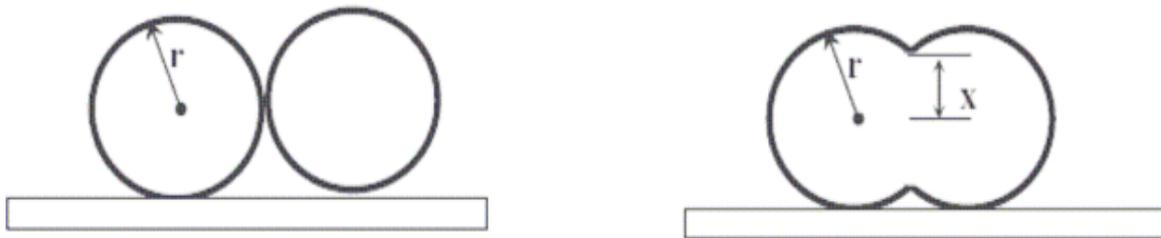
**Figure 66:** Evolution de l'interface au cours de la coalescence des deux grains de polymères.
