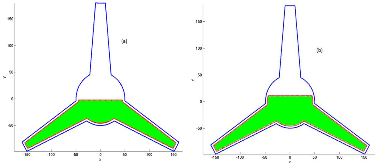
**Figure 55:** Détection des particules d'interface pour un moule d'hélice à trois pales à différents taux de remplissage. Le moule est représenté en bleu, le fluide en vert et l'interface en couleur rouge.
