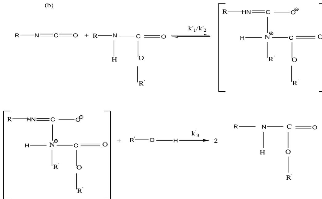
**Figure 27:** Mécanisme réactionnel par effet autocatalytique (a) alcool (b) uréthane [117,118].
