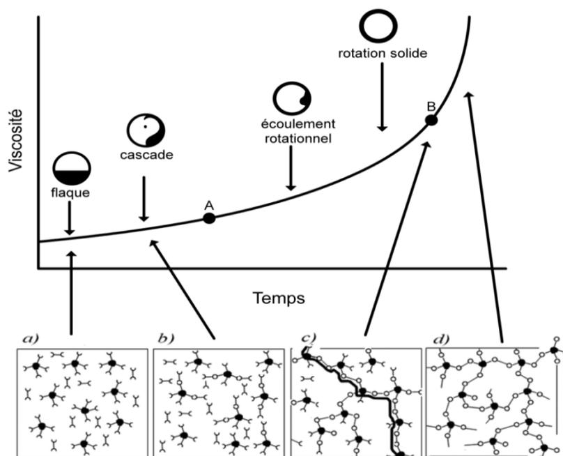
**Figure 4:** Différents régime d'écoulement lors du rotomoulage réactif.
