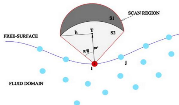
**Figure 50:**Détermination des particules d'interface par un scan conique [163].
