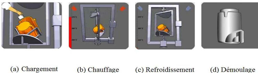
**Figure 1:** Les différentes phases de rotomoulage des poudres.
