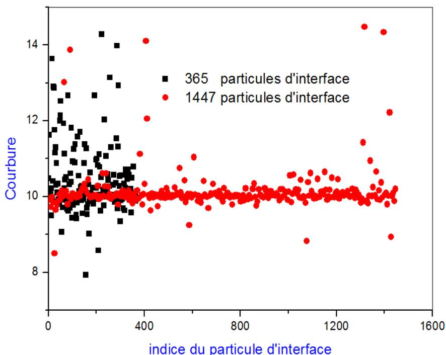
**Figure 72:** Evolution de la Courbure à la surface d'un cercle de rayon 0.1.
