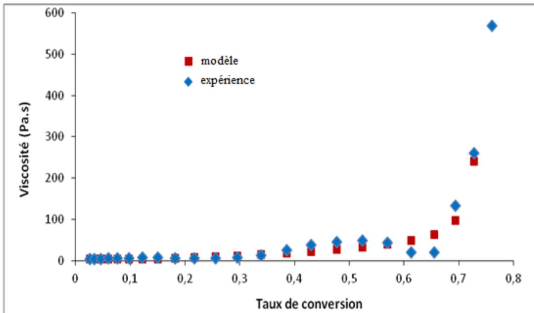
**Figure 39:**Confrontation modèle - expérience. Evolution de la viscosité en fonction du taux de conversion.
