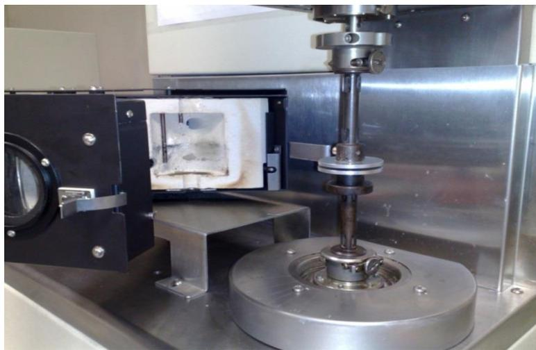
**Figure 18:** Rhéomètre ARES.
