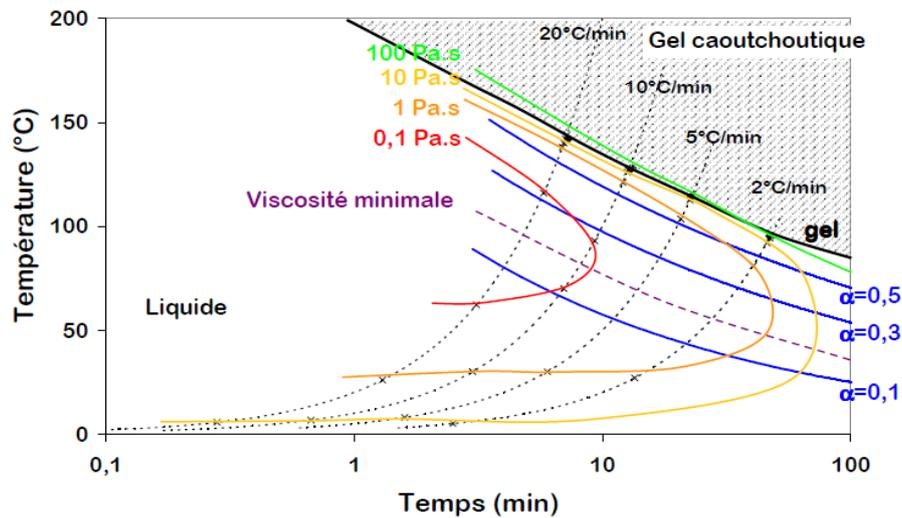
Figure 17: Diagramme CHT du système réactif polyol-isocyanates [27].
