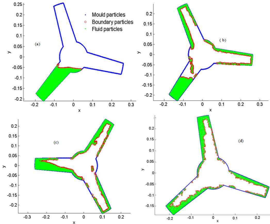
**Figure 58:**Détection des particules d'interface pour un moule d'une hélice à trois pales tournant autour de son axe principal à différents moments (a)  $t=0s$ , (b)  $t=5s$ , (c)  $t=10s$ , (d)  $t=20s$ .
