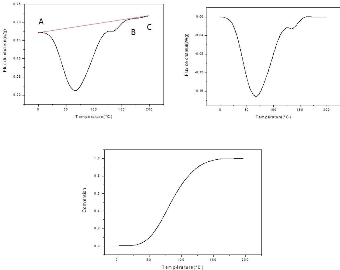
**Figure 24:** Méthodologie de calcul du taux de conversion en mode anisotherme.
