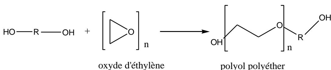
**Figure 10:** Exemple de synthèse des polyols polyéther
