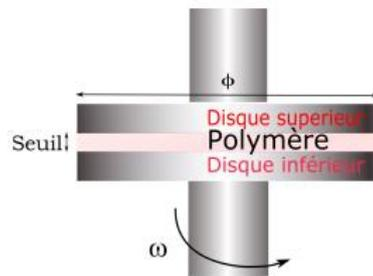
**Figure 19:** mesure de la viscosité en mode plan-plan.
