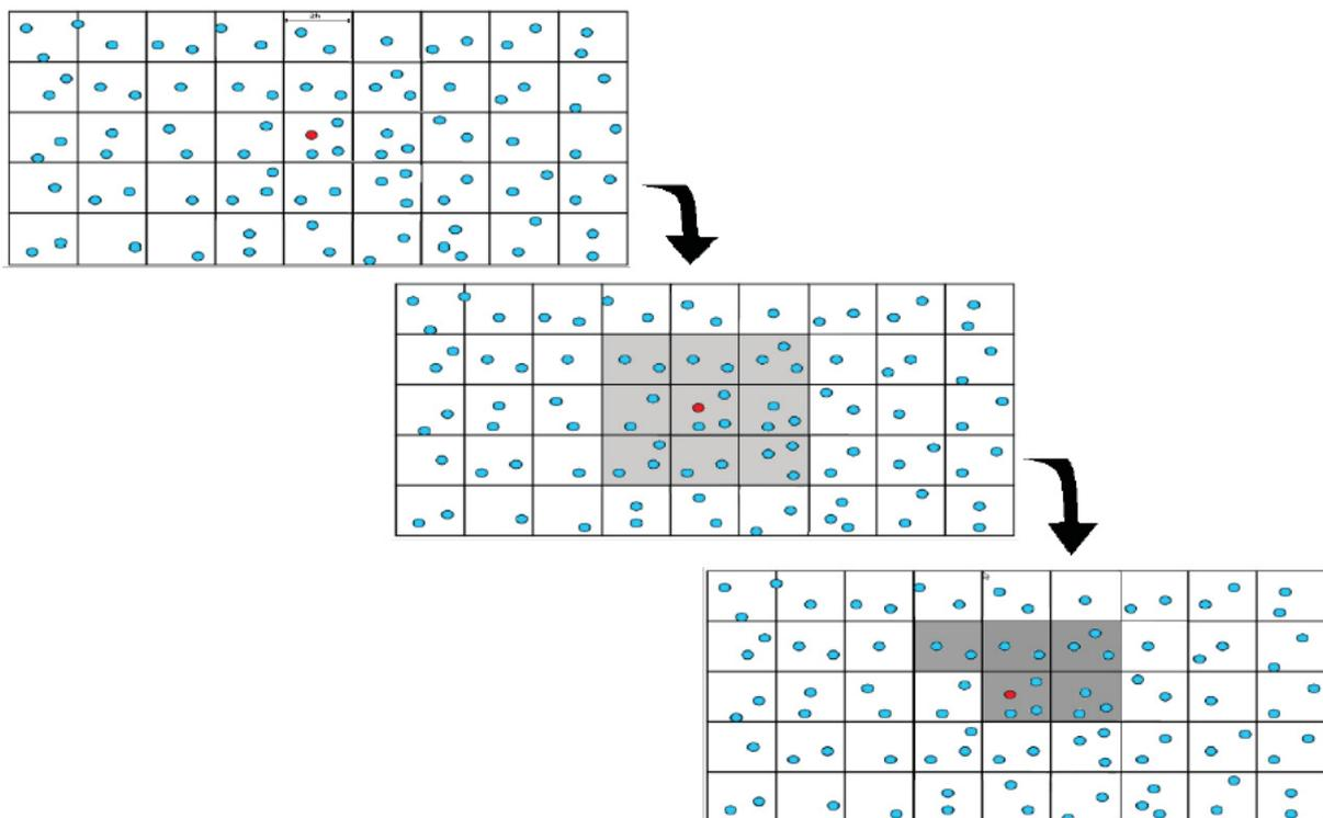
**Figure 42:** Recherche des voisins par l'algorithme linked-list.
