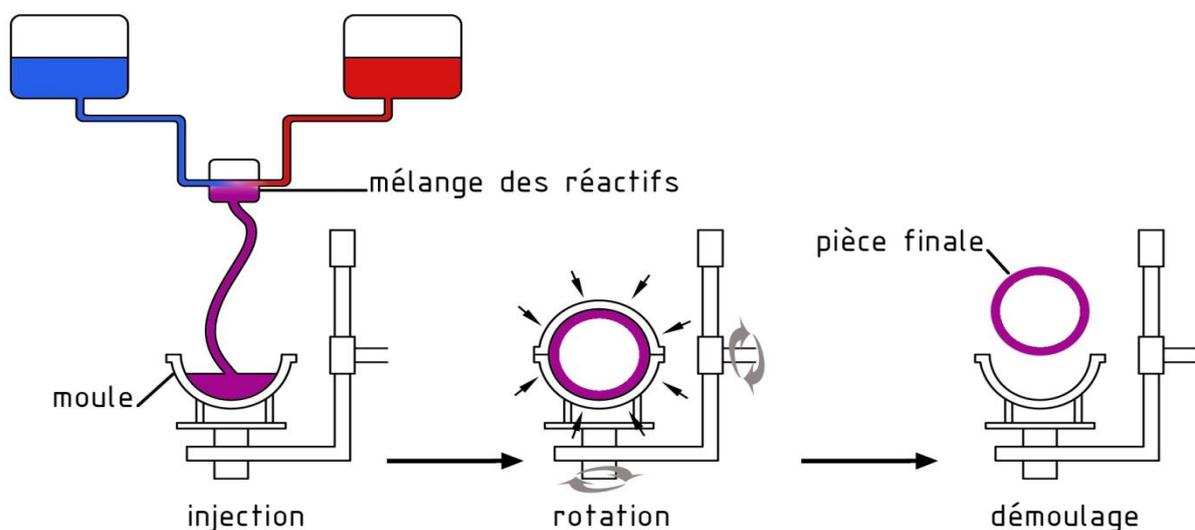
**Figure 2 :** Etapes principales du rotomoulage réactif.
