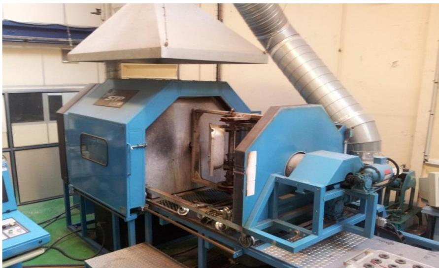
**Figure 20:** Machine de rotomoulage LAB 40 .
