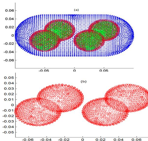
**Figure 60:**Détection de surface air-polymère en 3D. Le moule est représenté en bleu, le fluide en vert et l'interface en couleur rouge.
