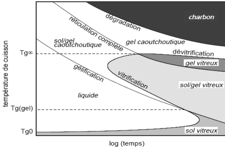
Figure 15: Diagramme Temps-Température-Transformation (TTT) théorique [102].
