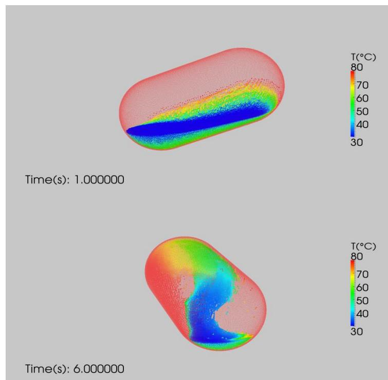
**Figure 7:** Résultats SPH pour le cylindre 3D (400 000 particules) [52].
