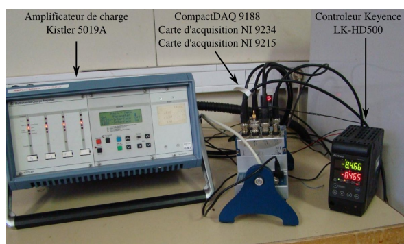
FIGURE 3.20 – Vue générale de la position des conditionneurs et cartes d'acquisitions.
