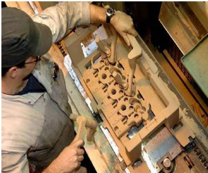
FIGURE I.1 – Fabrication d'une culasse par coulée en coquille [1]
