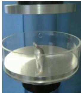
Figure 39 : Essai de compression d'un complexe musculo-tendineux de chien (d'après Gras *et al.*, 2011)
