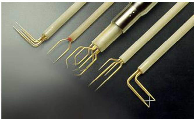
Figure 2-28 Différents types de fils chauds (Dantec)
