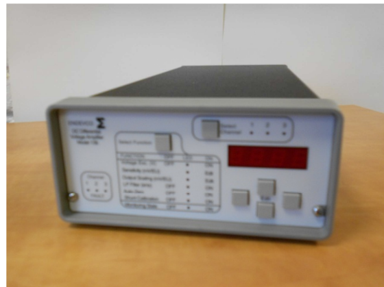
Figure 3-7 Conditionneur pour capteurs de pression ENDEVCO modèle 136
