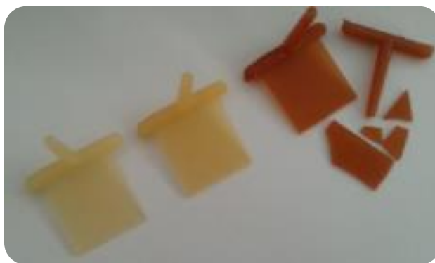
Figure 41. Photo de plaques de PA11 jaunies au cours d'un vieillissement sous air à 110 °C au bout de 200, 400 et 1000 heures.
