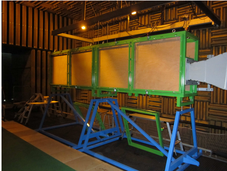
FIGURE 1.8 – Photographie de la veine SONOBL montée à la sortie de la soufflerie dans la chambre sourde du centre acoustique (sens de l'écoulement de la droite vers la gauche ici).
