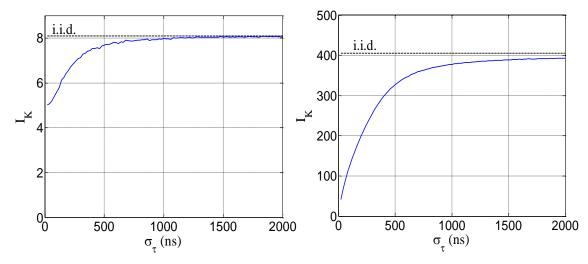
Figure 7  $I_K$  en fonction de l'étalement temporel  $\sigma_{ au}$  pour  $N_f=2$  (gauche) et  $N_f=100$  (droite)
