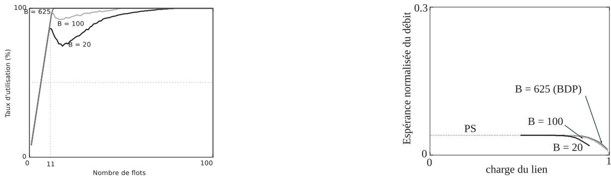
FIGURE 4.13 – Taux d'utilisation de la capacité résiduelle  $\phi(i)$  atteint pour chaque nombre  $i$  de flots en cours ; et espérance du débit  $\gamma$  d'un flot en fonction de la charge  $\rho$ , pour des flots *non-bottlenecked* de débit limité à 2Mb/s
