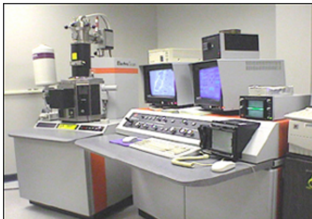
FIGURE 2.20 – Microscope Électronique à Balayage Electroscan E3 du Laboratoire des Géo-matériaux de l'Université de Marne La Vallée.
