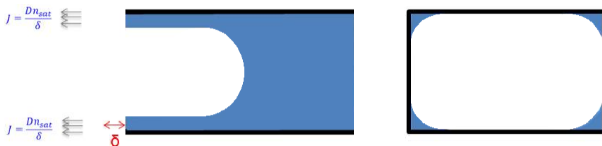
FIGURE 3.4 – Schéma de principe du séchage d’une solution d’eau distillée dans un capillaire rectangulaire hydrophile. Image de gauche : vue de dessus. Image de droite : vue de la section transversale.
