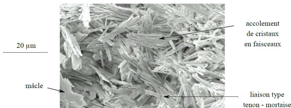
FIGURE 1.3 – Micrographie d'un faciès de plâtre pris ( E/P = 0,8 ) [2]
