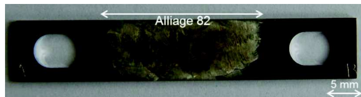
Figure II-6 : Macrographie d'une plaquette prélevée dans un moule de soudure
