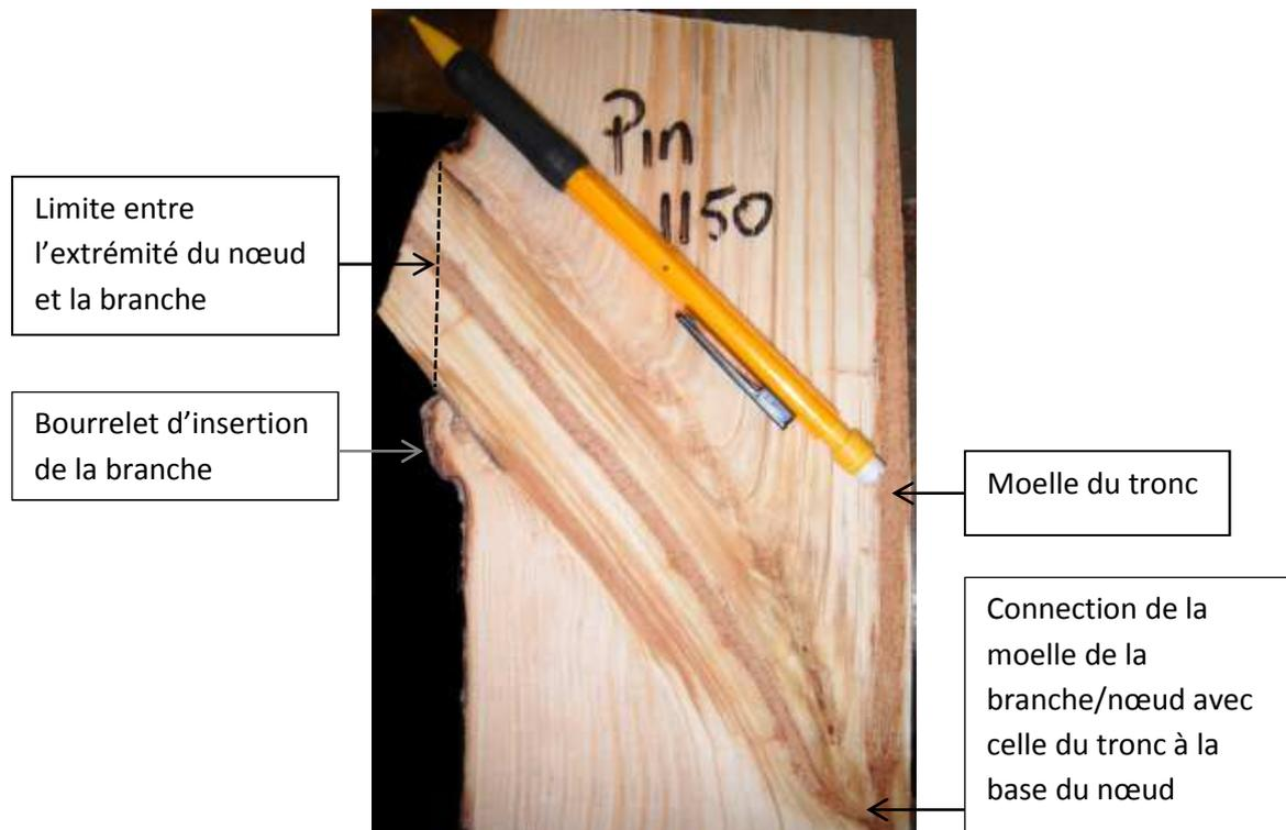
Figure 1 : Illustration d'un nœud de pin sylvestre.
