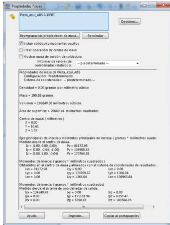
FIGURE 93 EXEMPLE DE PROPRIÉTÉS PHYSIQUES - SOLIDWORKS®
