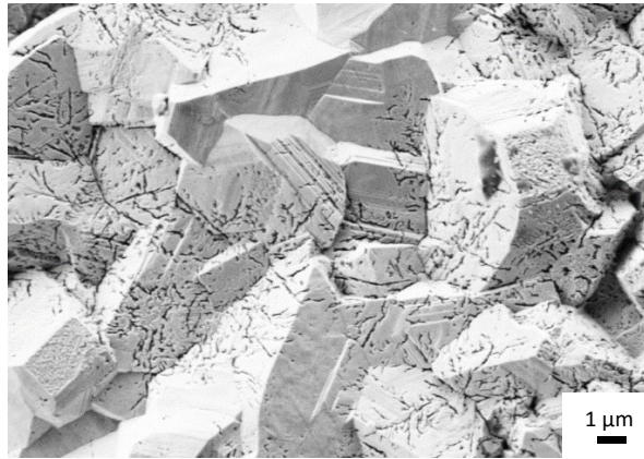
Figure 4.15 : Surface après 5 s de réduction.
