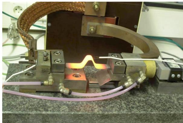
FIGURE 1.6 – Photographie de l'éprouvette de fatigue thermique chauffée par effet Joule [12]
