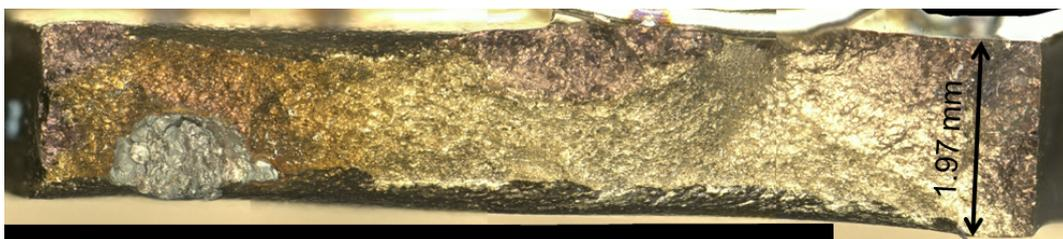
FIGURE C.14 – Faciès de rupture d'une éprouvette en tôle,  $\Delta\varepsilon = 0.4 \%$
