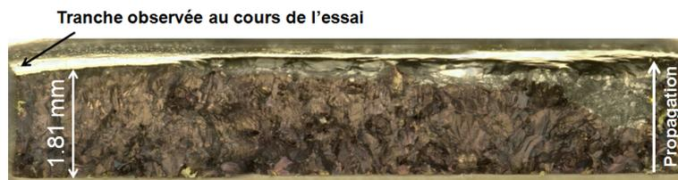
FIGURE 3.38 – Faciès de rupture de l'éprouvette en tôle soudée arasée,  $\Delta\varepsilon = 0.4 \%$
