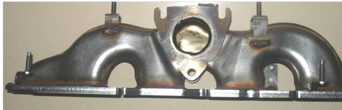
FIGURE 1.2 – Collecteur en tôle soudée pour application Diesel
