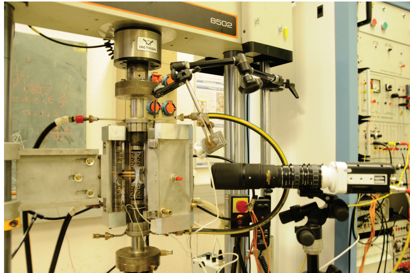
FIGURE 2.8: Photographie de la caméra ultra rapide installée pour un essai à haute fréquence
