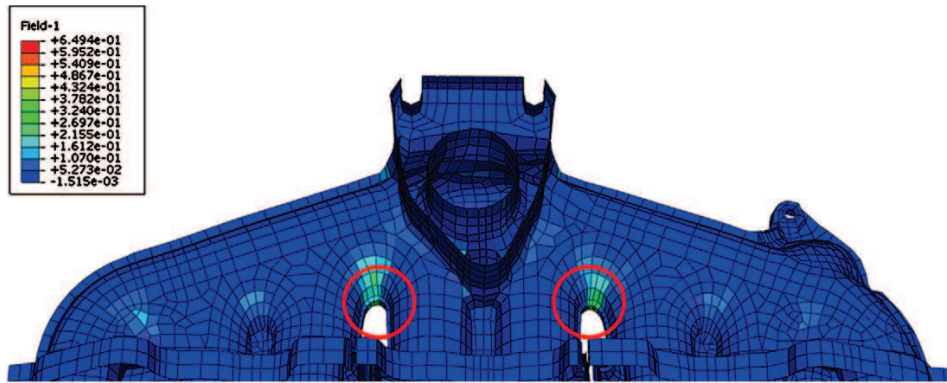
FIGURE 1.10: Résultats mécaniques pour un collecteur d'échappement 2L - Énergie dissipée pour le 12 ème cycle de chargement - modèle Szmytka et al. [Szmytka et al., 2010]
