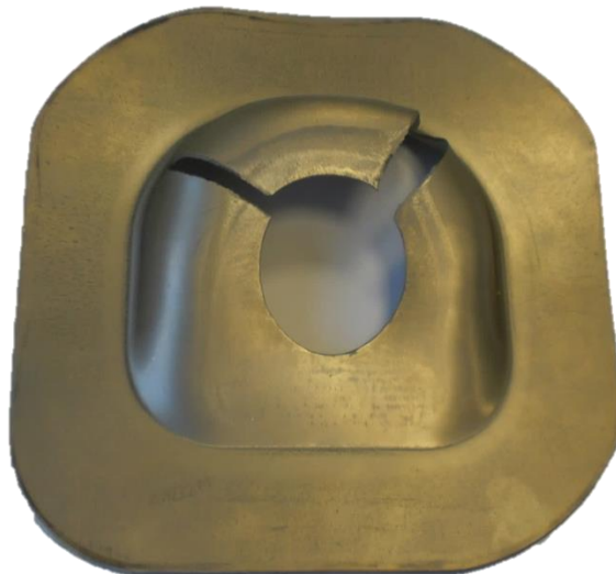
Figure 3.20 - Pièce en T40 endommagée (avec une pression de 500 bars)
