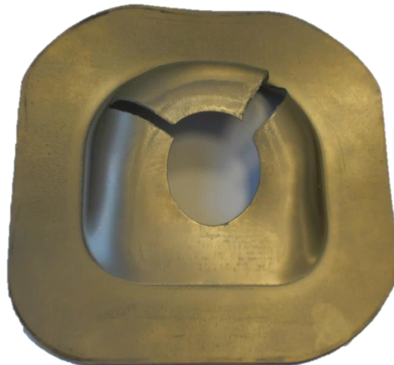
Figure 3.20 - Pièce en T40 endommagée (avec une pression de 500 bars)
