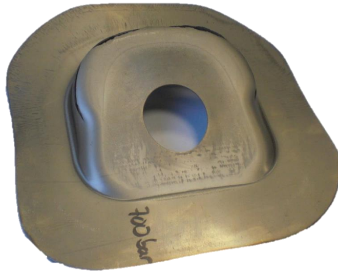
Figure 3.22 - Pièce en T40 endommagée (avec une pression de 700 bars)
