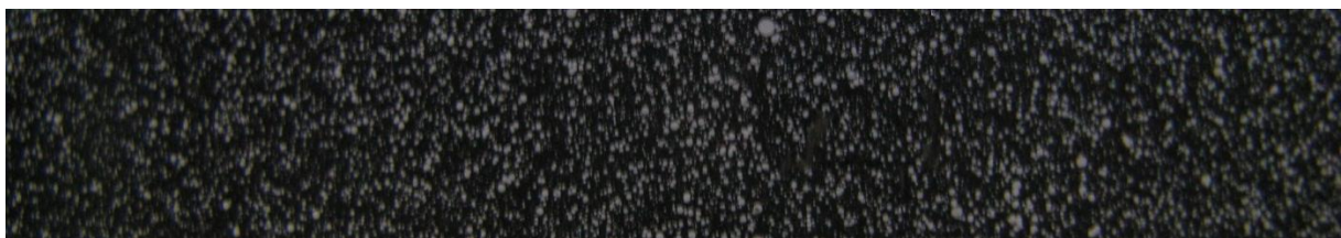
Figure 2.40 - Mouchetis de peinture sur l'éprouvette de traction
