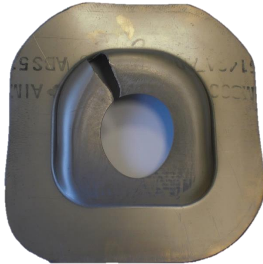
Figure 3.21 - Pièce en T40 endommagée (avec une pression de 600 bars)
