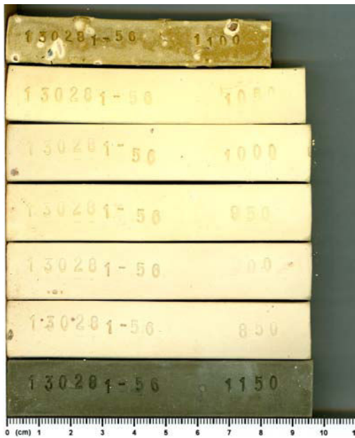
Figure 4-48 : Photographie des éprouvettes Cuissons Mesures de l'estuaire de la Rance (130281-56)
