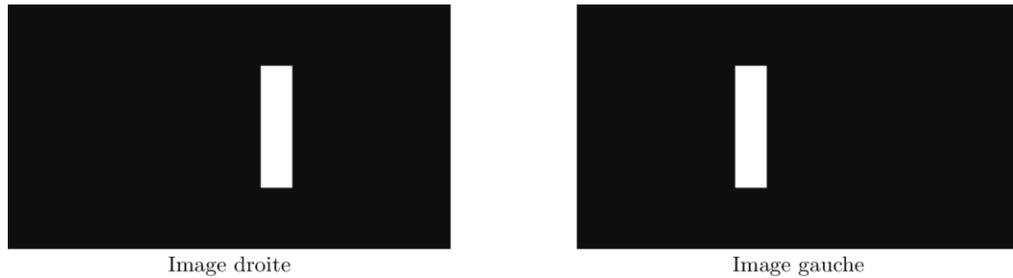
Figure 29 : le test proposé par (ITU 2012) pour mesurer la limite de fusion.
