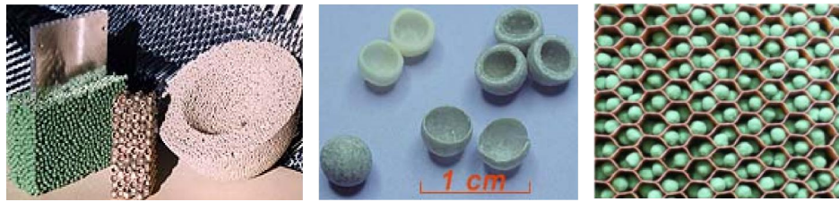
FIGURE 2.15 – Exemples de sphères creuses ATECA, de gauche à droite : moulages de différentes géométries, sphères creuses céramiques et polymères, incorporation de sphères creuses dans un nid d'abeilles (brevet SIMON et collab. [2015] )
