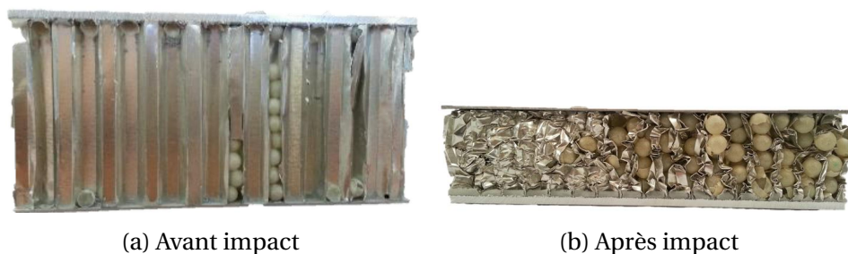
FIGURE 2.21 – Éprouvette avant et après un essai de compression dynamique v \approx 5,7 \text{ m.s}^{-1} sur un nid d'abeilles rempli de sphères creuses
