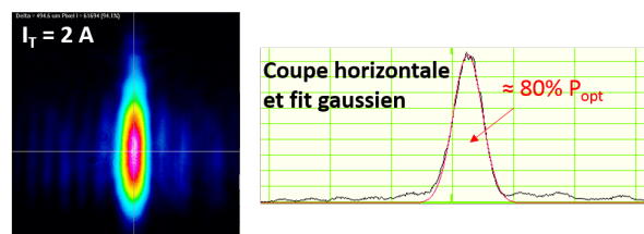
FIGURE IV.42: Profil spatial du faisceau combiné à I_T = 2 A avec sa coupe dans la direction horizontale.
