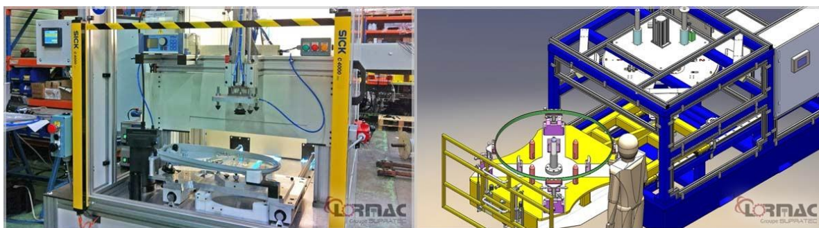
Figure 1. Machines spéciales d'assemblage pour le collage de luminaires (gauche) et l'assemblage par frettage des couronnes abrasives (droite) (Lormac, 2016)
