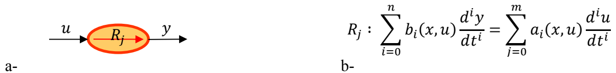
fig. 1-10 – Représentation graphique (a) et comportement associé (b) d'un modèle causal
