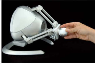
fig. 2-4 – Organe de retour haptique Falcon (Novint Inc.)
