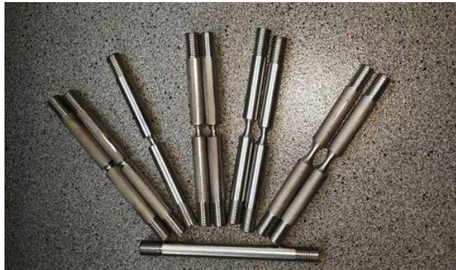
Figure III-27 : Éprouvettes entaillées de traction pour l'alliage 2050
