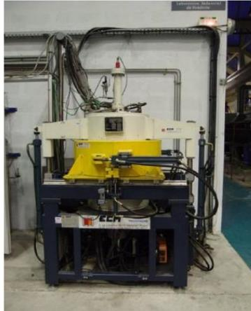
Figure VI-2 : Machine de gonflage de l'ENSAM (Boude, 1994)
