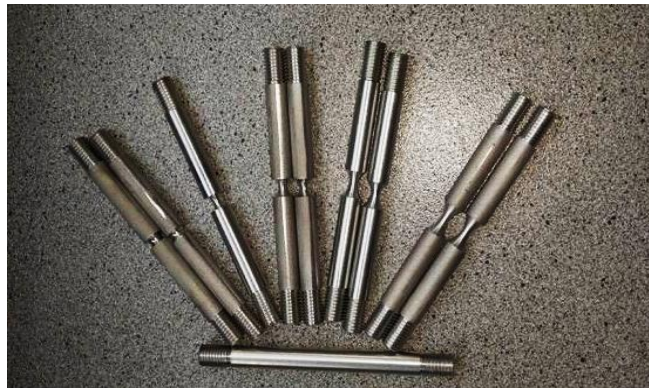
Figure III-27 : Éprouvettes entaillées de traction pour l'alliage 2050
