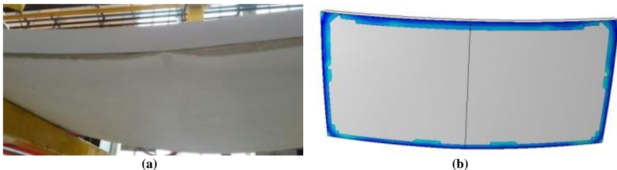
Figure V-15 : Zones de contact sur la surface inférieure de la tôle, (a) résultat expérimental, (b) résultat numérique
