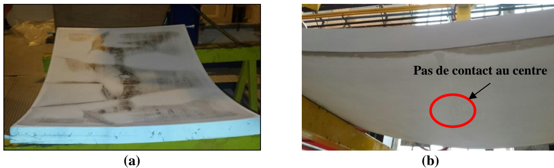
Figure V-19 : Forme de la pièce obtenue et traces de contact sur la surface (a) supérieure et (b) inférieure de la tôle
