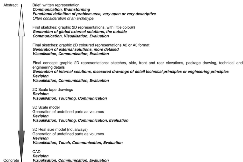
Figure 19 Classification et fonction des RI dans le processus traditionnel selon Bouchard, et al. [66]
