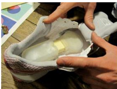
Figure 75 Preuve de concept illustrant l'amortissement par gel (projet 13)
