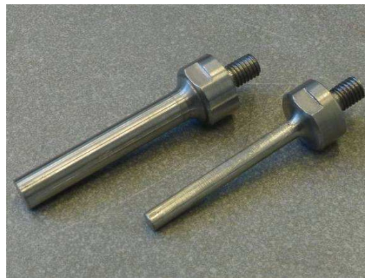
Figure V.12 Embouts cylindriques de l'impacteur, diamètre: 10 mm (à gauche) et 6 mm (à droite)
