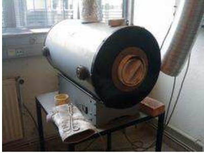
Figure II.13 Four à haute température
