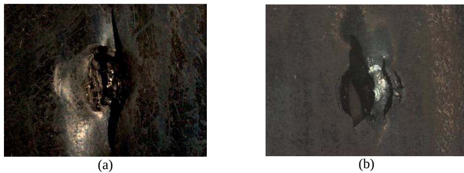
Figure VI.14 Perforation : (a) Essai d'indentation, (b) Essai d'impact par masse tombante
