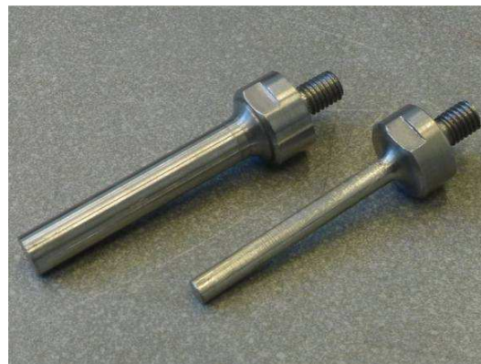
Figure V.12 Embouts cylindriques de l'impacteur, diamètre: 10 mm (à gauche) et 6 mm (à droite)
