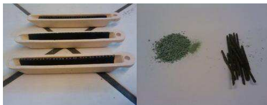
Figure II.14 Eprouvettes avant et après brûlées
