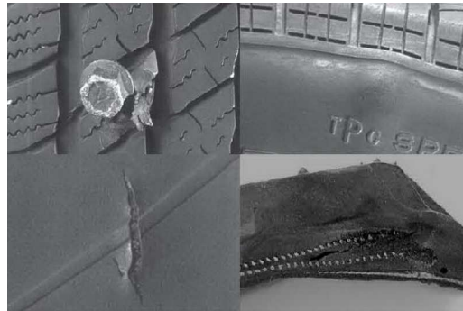
Figure I.2 Endommagement d'un pneu par choc
