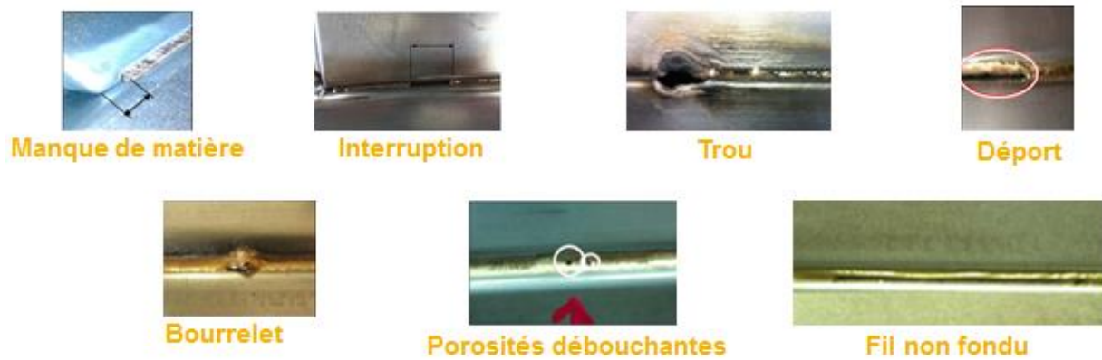
Figure I.18 – Liste des principaux défauts pouvant apparaître lors de l'opération de soudo-brasage.
