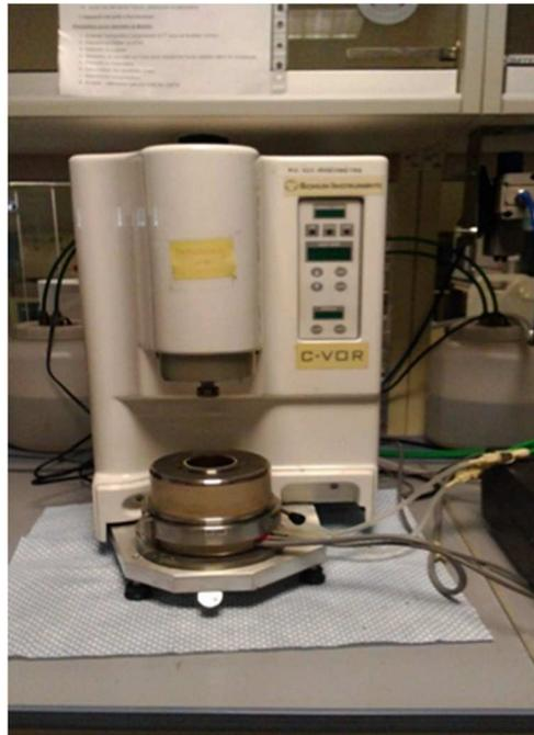
Figure 29 : Rhéomètre CVOR Bohlin de l'ESTP-IRC, avec système de régulation de température
