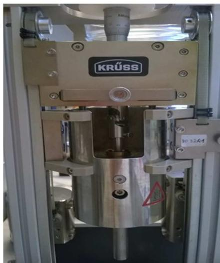
Figure 21 : Dispositif en laiton pour essais sur bitume à haute température
