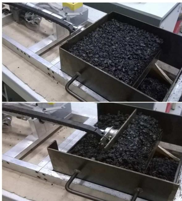
Figure 61 : Déroulement d'un essai au maniabilimètre sur un enrobé
