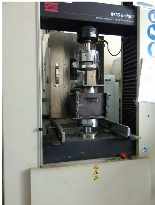
Figure 115. Mise en position de l'assemblage dans la presse
