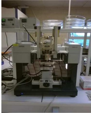
Figure 20 : Tensiomètre à goutte
