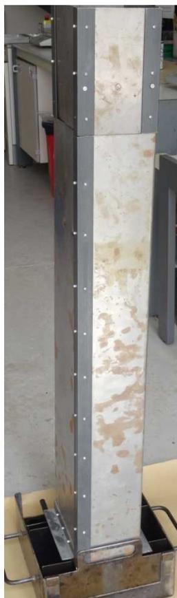
Figure 63 : Goulotte de remplissage pour le petit moule du maniabilimètre
