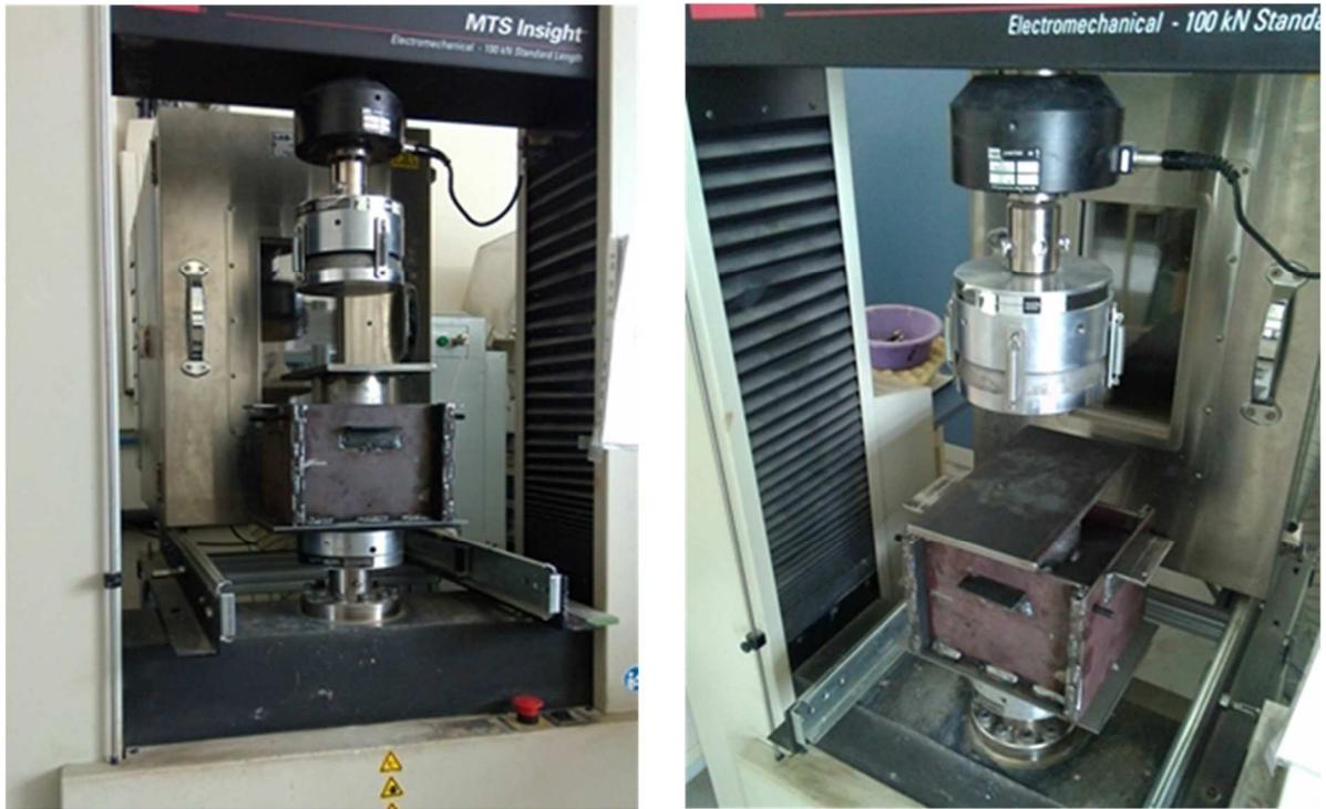
Figure 74 : Compactage dans le moule renforcé à l'aide d'une presse MTS
