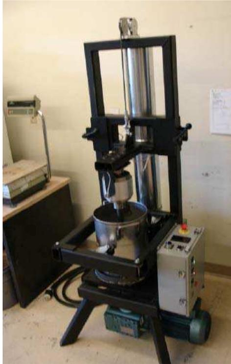
Figure 13 : Asphalt Workability Device développé par l'Université du Massachusetts (Dartmouth) [Bennert et al., 2010]
