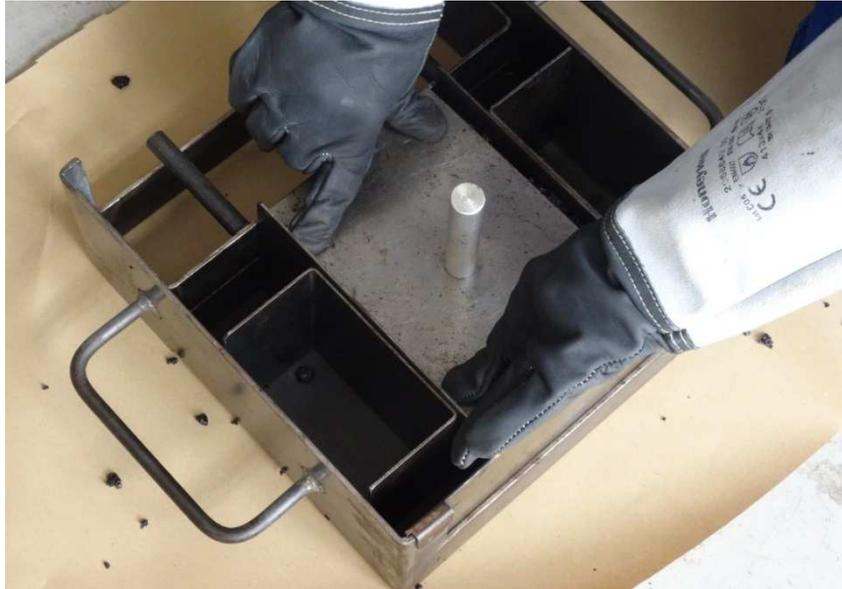
Figure 69 : Tassement manuel de l'échantillon d'enrobé dans le moule après déversement à la goulotte
