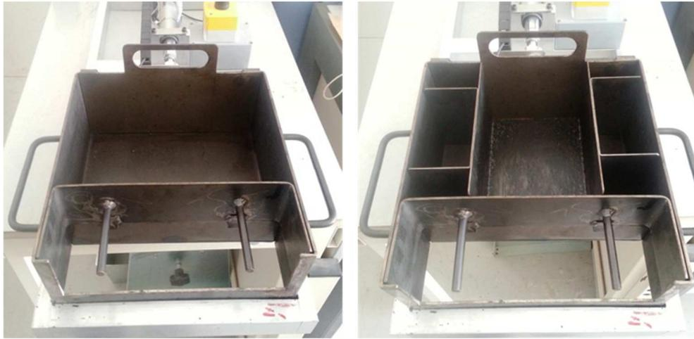
Figure 62 : Moules du maniabilimètre
