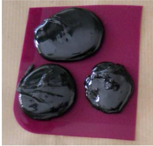
Figure 28 : Echantillons de mastics bitumineux pour les mesures de viscosité
