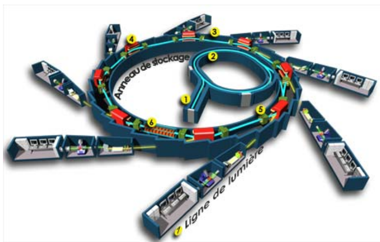
FIGURE 3.6 – Schéma de principe d'un synchrotron.
