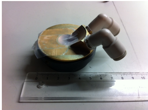
(a) Photographie de la face avant de la monture. La zone où apparaît le diamant collé à la structure est recouverte par un scotch de protection.
