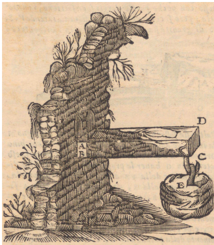
(a) Schéma historique de l'expérience de la poutre de Galilée [38]
