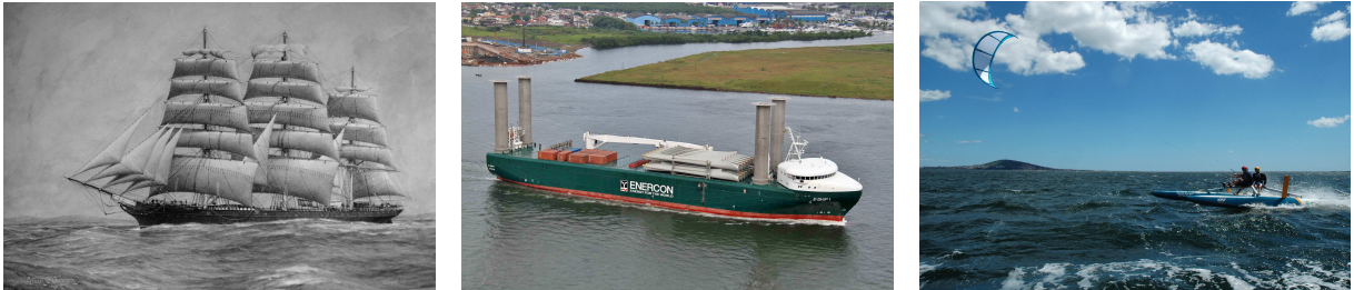
(a) Peinture du clipper Salamis toutes voiles dehors par Allan C. Green (1927) (b) Photographie du navire E-ship 1 propulsé par des rotors de Flettner (c) Photographie d'un catamaran tracté par un cerf-volant
