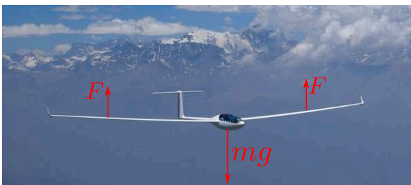
(a) Planeur en vol et représentations des forces exercées sur les ailes
