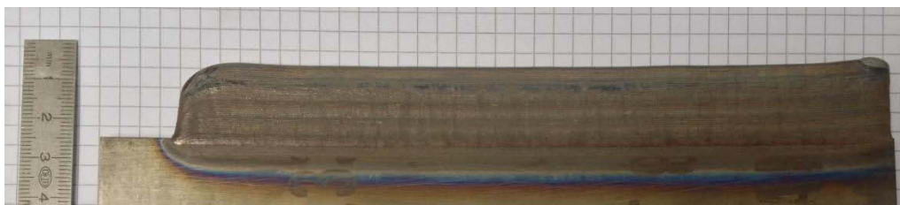
Figure III.11 – Exemple d’un mur élaboré pour l’identification (P700V100Dm1)
