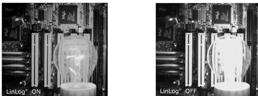
Figure II.33 – Exemple d'une image capturée avec et sans la technologie LINLOG (Source : photonfocus.com)
