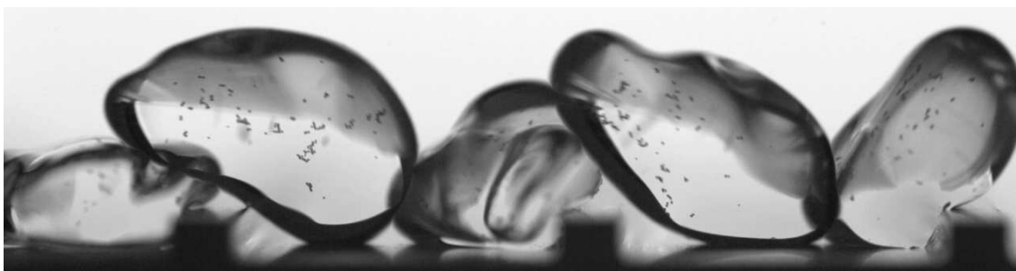
FIGURE 6.38 – Saut de haie. Goutte de 100\ \mu\text{L} , de 10\ \text{mPa}\cdot\text{s} qui dévale une plaque inclinée à 12,4^\circ .
