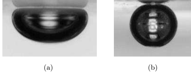
FIGURE 2.13 – Formes de bulles juste avant que le contact ne soit établi avec la plaque (a) sans rebond, (b) après de nombreux rebonds. Les deux bulles ont un rayon R \approx 1 mm.
