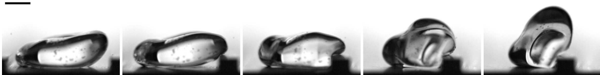
FIGURE 6.33 – Goutte de volume \Omega = 100 \mu\text{L} sur une plaque \lambda = 8 + 1,5 mm, inclinée à \alpha = 12,4^\circ . La goutte a une viscosité \eta = 10 mPa.s. L'intervalle de temps entre deux photos vaut 3,8 ms et la barre d'échelle indique 2 mm.
