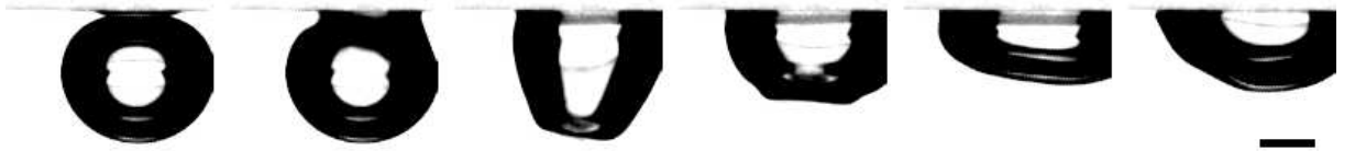
FIGURE 2.20 – Étalement d’une bulle de rayon R = 1,3 mm sur une plaque en mouillage partiel (angle final de 62^\circ \pm 2^\circ ). Les images sont espacées de 0,25 ms et la barre d’échelle indique 1 mm.
