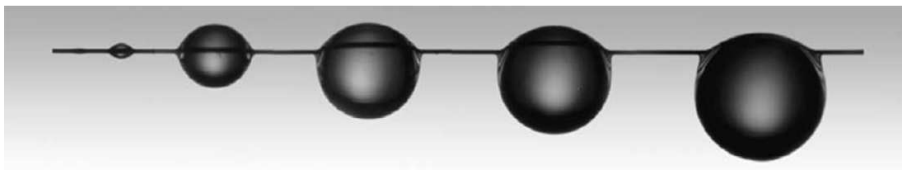
FIGURE 2.31 – Gouttes d'huile silicone de volume \Omega = 0.01, 0.10, 0.23, 0.32 et 0.52 \text{ mm}^3 , de gauche à droite, suspendues sur une fibre horizontale de rayon b = 12 \text{ }\mu\text{m} . (Crédit : E. Lorenceau [92]).
