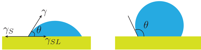
FIGURE 1.4 – Goutte sur deux substrats différents : le schéma de gauche montre un cas hydrophile, où l’angle de contact \theta_e est aigu ; le schéma de droite montre un cas hydrophobe, où l’angle de contact \theta_e est obtus.
