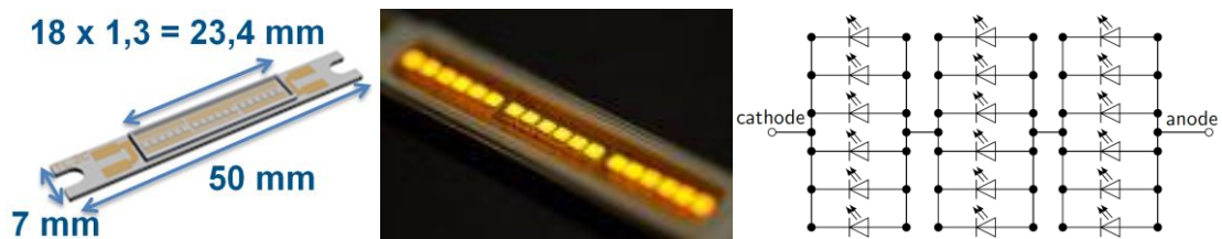
Figure II-20 : À gauche et au milieu: LED disposées linéairement utilisées pour le pompage du \text{Nd:YVO}_4 , à droite : le circuit électrique de ces LEDs, source : Chips4Light.
