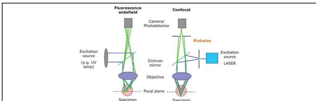
**Figure 11. Trajets optiques des deux types de microscopie: par champs large et confocale.**
