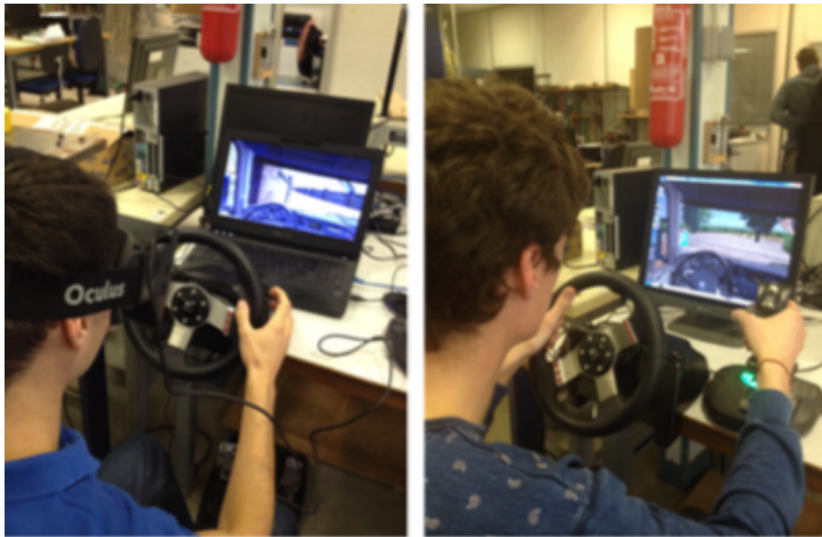
FIGURE 7.3 – L'installation utilisée par les sujets de l'expérience, avec l'Oculus Rift (à gauche) et avec l'écran (à droite). Sur ces images on peut voir le volant. Sur l'image de gauche, on aperçoit le pédalier, l'écran est présent comme moyen de surveillance par l'opérateur en charge de l'expérience. Sur l'image de droite, on voit le joystick.
