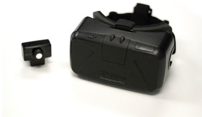
FIGURE 7.2 – Vue frontale d'un Oculus Rift DK2. Cette photographie illustre le casque dans lequel sont installés un écran, la centrale inertielle et la caméra infrarouge permettant le suivi en translation du casque.
