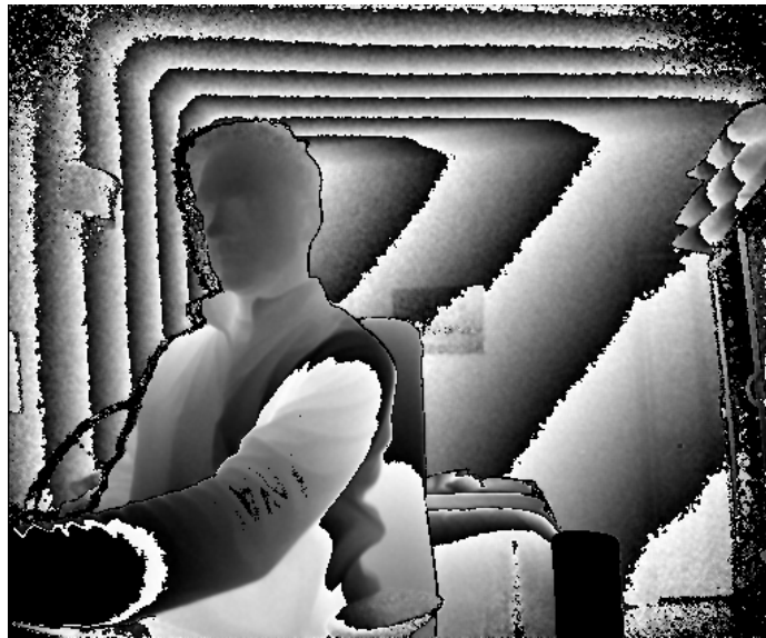
FIGURE 3.8 – Les « murs de profondeurs » liés aux impulsions lumineuses avec une Kinect 2 . http://www.bryancook.net
