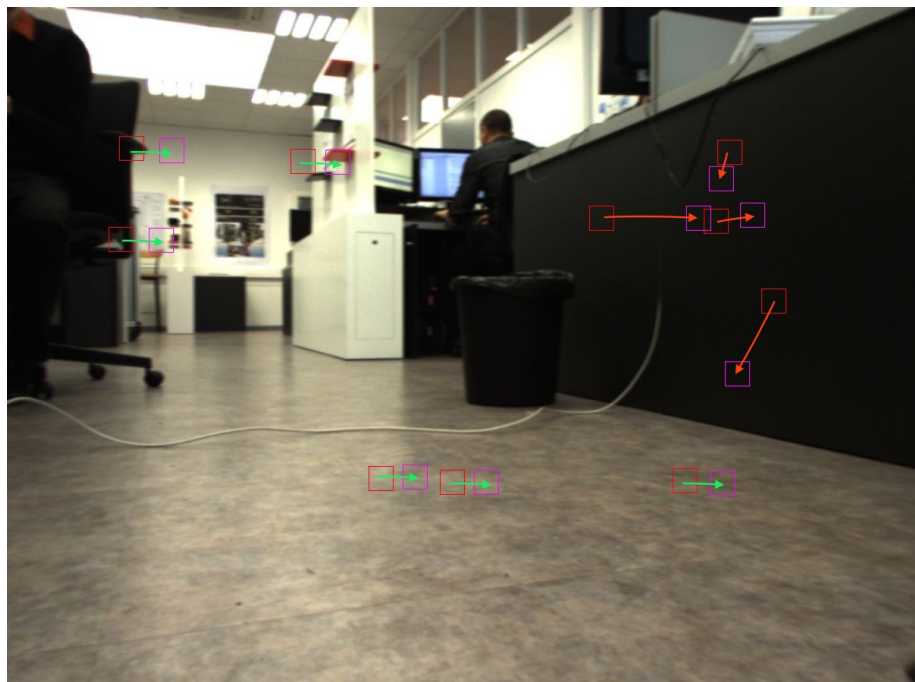
FIGURE 5.21 – Cette figure montre les erreurs liées au choix d'imagettes homogènes. En rouge les positions des imagettes dans l'image précédente et en violet, leur positionnement dans l'image actuelle. Les flèches permettent de voir les correspondances entre les carrés.
