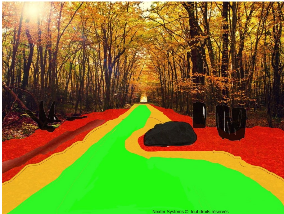
FIGURE 1.4 – Rendu prévisionnel de la solution finale de notre ADAS. La zone verte est la zone sûre sur laquelle le pilote peut rouler. La zone rouge est une zone dangereuse, car des obstacles, en noir, ont été détectés. La zone jaune est une zone intermédiaire dans laquelle une attention particulière est nécessaire.
