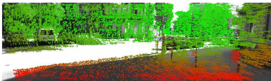
FIGURE 5.4 – Le flux optique - qui représente l'ensemble des vecteurs de déplacement des points d'intérêt - calculé par Libviso 2 . On remarque les vecteurs de mouvements des points d'intérêt dont la couleur indique la distance vis-à-vis de l'observateur. Le rouge indique une distance proche et le vert une distance lointaine. L' egomotion estime l'inverse du mouvement moyen de ce flux optique (chapitre 2.2.2.2 page 27) . Extrait de [Kitt et al., 2010]
