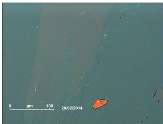
FIGURE 3.20 – Image prise au microscope optique d'un échantillon de graphène présentant des trous
