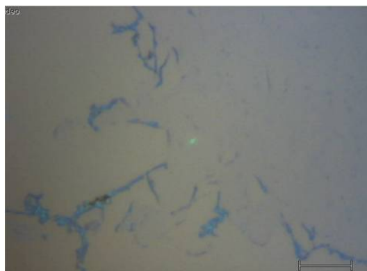
FIGURE D.2 – Traces de résine sur l'échantillon Box 92F-CDH2
