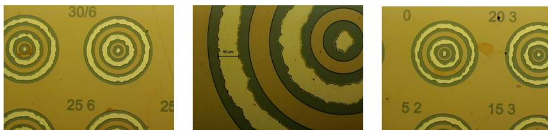
FIGURE 4.32 – Images microscope optique de l'échantillon graphène sans décapage ionique après 1min30 de gravure
