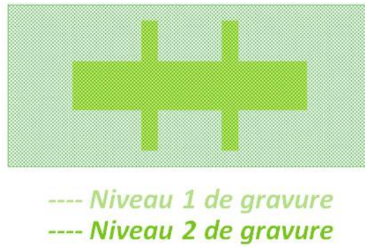
FIGURE 4.46 – Définition du canal de graphène en deux étapes de gravure ; exemple d'une croix de Hall
