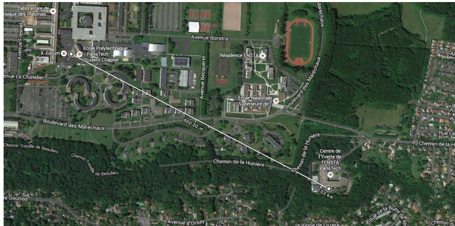
FIGURE 9.1 Ligne de visée approximative pour le lidar COWI du LMD sur le site de l'Ecole Polytechnique. La salle lidar se trouvant à peu près au niveau du u de X-Forum. Le faisceau laser passe quelques mètres au dessus des bâtiments du campus. La direction est imposée par une ouverture dans la barrière de peupliers : il y a peu de directions pour lesquelles on puisse tirer pratiquement à l'horizontale.
