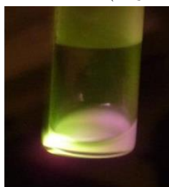
Figure 121 - Luminescence associée de NaYF 4 @AL@CL dispersées dans du 5CB ( \Phi = 3,4 \% ).
