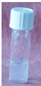
Figure 125 - Bâtonnets de \text{LaPO}_4 dispersés dans le DMSO ( \Phi=1,1 %).
