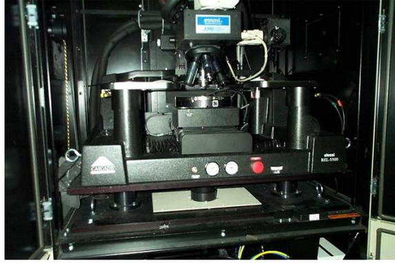
FIGURE 3.29: Photo d'un appareil de caractérisation EMMI.
