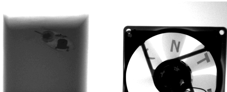
FIGURE 4.58: Images RX a) d'un poisson mécanique dans l'eau et b) d'un ventilateur, obtenues avec une cathode à nanotubes de carbone à grille.
