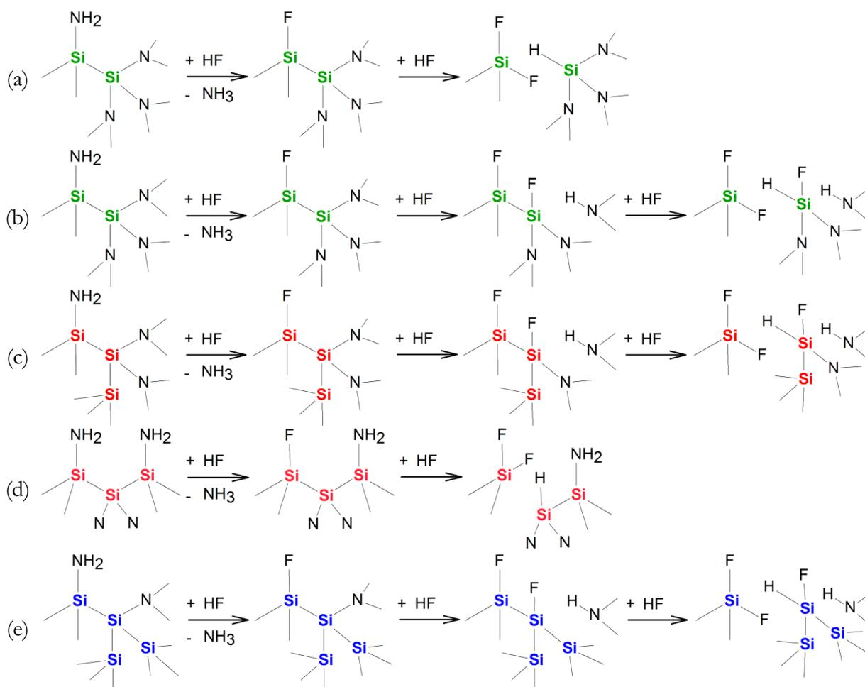
Figure 53 : Mécanismes possibles de formation des différentes espèces hydrogénées présentes en surface du  $\text{Si}_5\text{N}_4$  décapé au HF. Ces espèces hydrogénées nécessitent la présence de dimères (a) et (b), de trimères (c) et (d) ou quadrimères (e) d'atomes de silicium.
