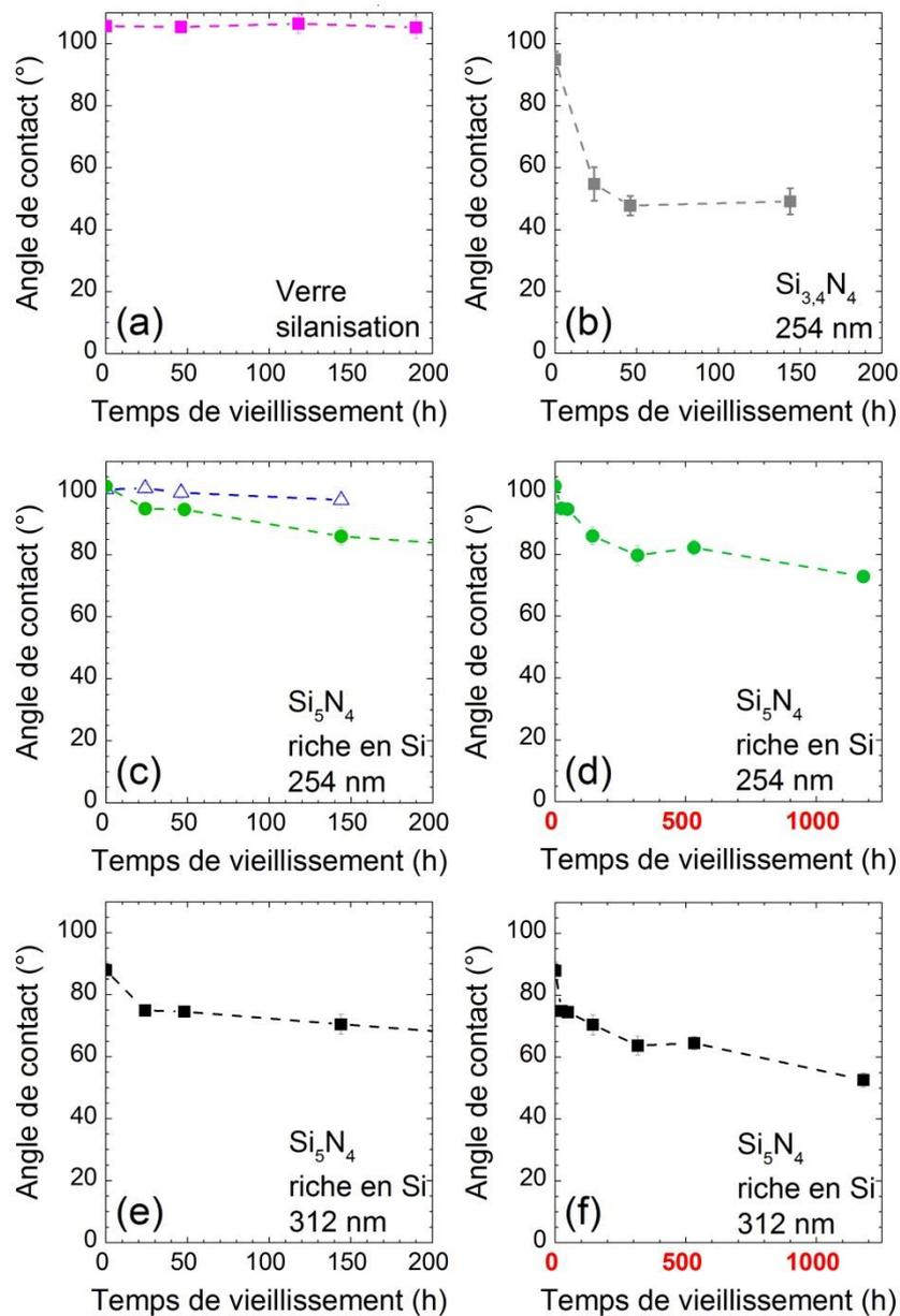
Figure 81 : Angles de contact de surfaces de nitrure de silicium déposées sur verre Si<sub>3,4</sub>N<sub>4</sub> (b) et Si<sub>5</sub>N<sub>4</sub> (c à f) fonctionnalisées avec le 1-décène sous UV 24 h 254 nm (b, c & d) et 312 nm (e & f) et de verre silanisé avec le n-décyltriéthoxysilane (a) lors du vieillissement en brouillard salin neutre (BSN) pendant 200 h (a, b, c, e) et 1200 h (d & f). Pour la figure (c), le test a été réalisé sur deux échantillons différents à deux dates différentes.
