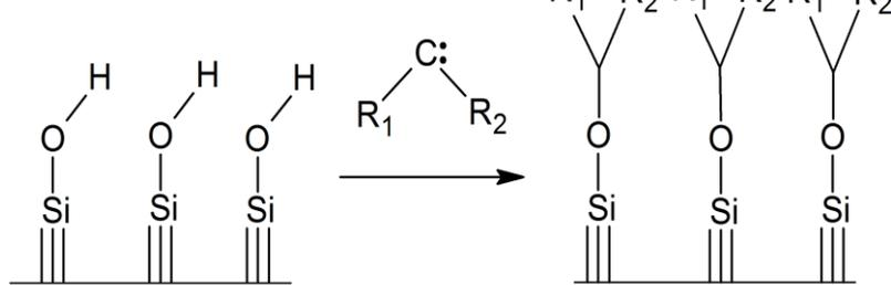
Figure 54 : Réaction des silanols de surface avec une diazirine sous irradiation UV.
