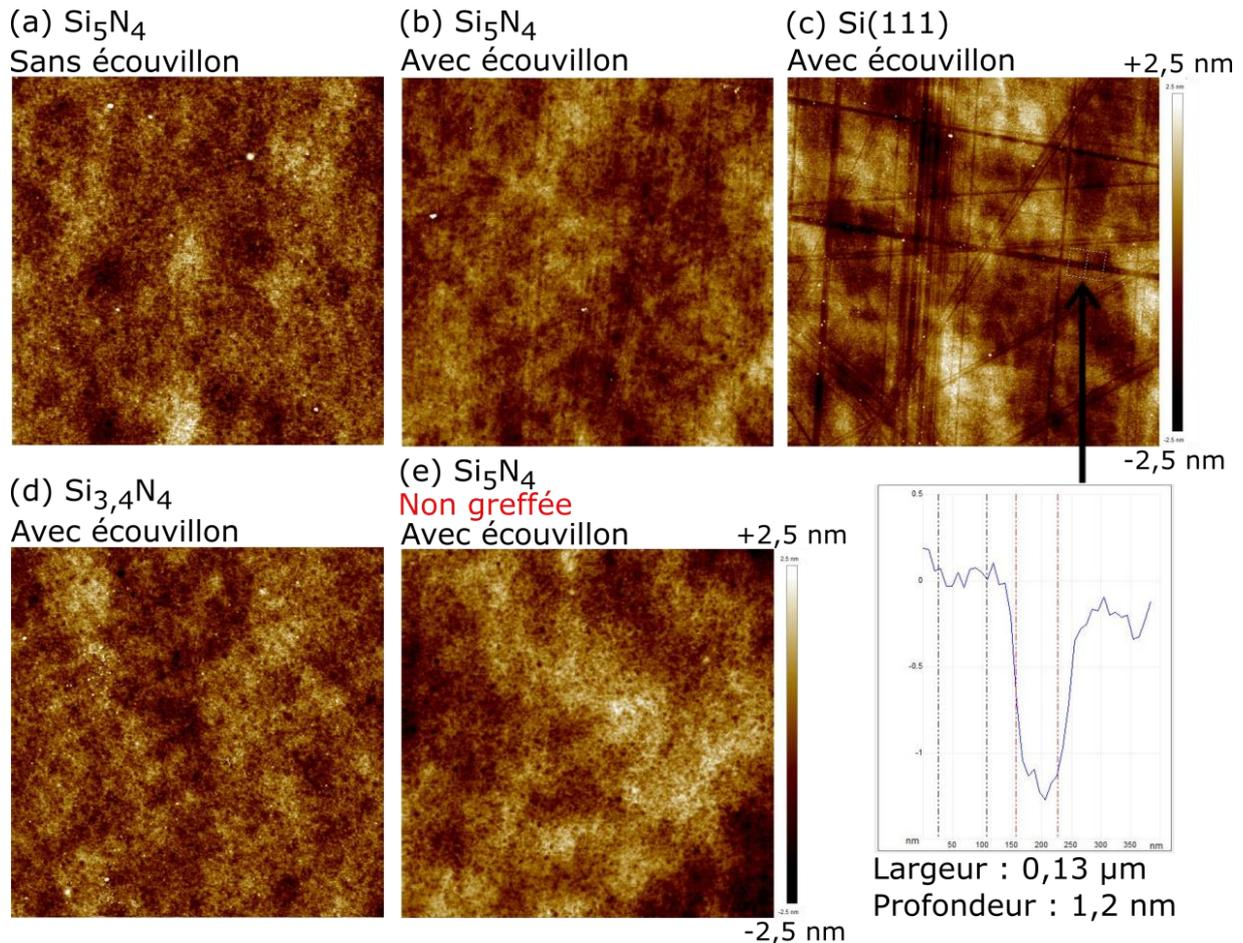
Figure 75 : Images AFM ( $5 \times 5 \mu\text{m}^2$ ) d'une surface de nitrure de silicium de  $\text{Si}_5\text{N}_4$  enrichi (a) & (b),  $\text{Si}_{3,4}\text{N}_4$  non enrichi (d), et de  $\text{Si}(111)$  (c) fonctionnalisée avec le 1-décène sous irradiation UV 254 nm, 24 h et non rincée (a) ou rincée (b), (c) & (d) avec l'écouvillon imbibé de THF. L'image AFM (e) est une surface de nitrure de silicium  $\text{Si}_5\text{N}_4$  non fonctionnalisée et rincée avec l'écouvillon imbibé de THF.
