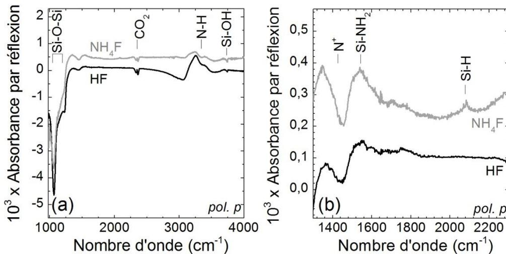
Figure 33 : Spectres infrarouges, en géométrie ATR, en polarisation  $p$ , de  $900$  à  $4000\text{ cm}^{-1}$  (a) et de  $1300$  à  $2300\text{ cm}^{-1}$  (b) d'une surface de  $\text{Si}_{3,4}\text{N}_4$  décapée  $30\text{ s}$  dans une solution de HF  $0,2\%$  ou  $15\text{ min}$  dans une solution de  $\text{NH}_4\text{F}$   $40\%$ . La surface de référence est la même surface avant décapage.
