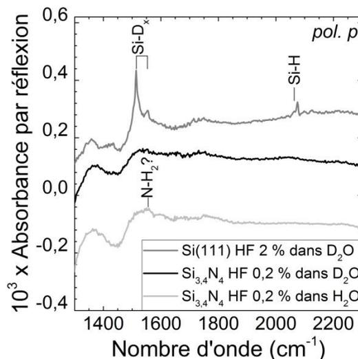
Figure 17 : Spectres infrarouges, en géométrie ATR, en polarisation  $p$ , de  $1300$  à  $2300\text{ cm}^{-1}$  d'une surface de Si(111) décapée 2 min par une solution de HF 2 % diluée dans  $\text{D}_2\text{O}$  et d'une surface de  $\text{Si}_{3,4}\text{N}_4$  décapée 30 s dans une solution de HF 0,2 % diluée dans  $\text{D}_2\text{O}$  ou dans  $\text{H}_2\text{O}$ . La surface de référence est la même surface après nettoyage dans une solution de « piranha ».
