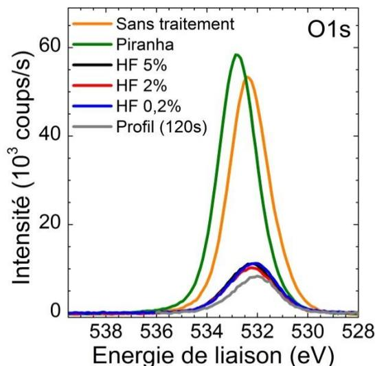
Figure 13 : Spectres XPS dans la zone O1s d'une surface de  $\text{Si}_{3,4}\text{N}_4$  sans traitement, après traitement dans une solution de « piranha » et après 30 s de décapage dans une solution de HF de différentes concentrations (0,2 à 5 %). L'énergie des pics a été décalée en fixant l'énergie du pic du carbone C1s à 285,0 eV.
