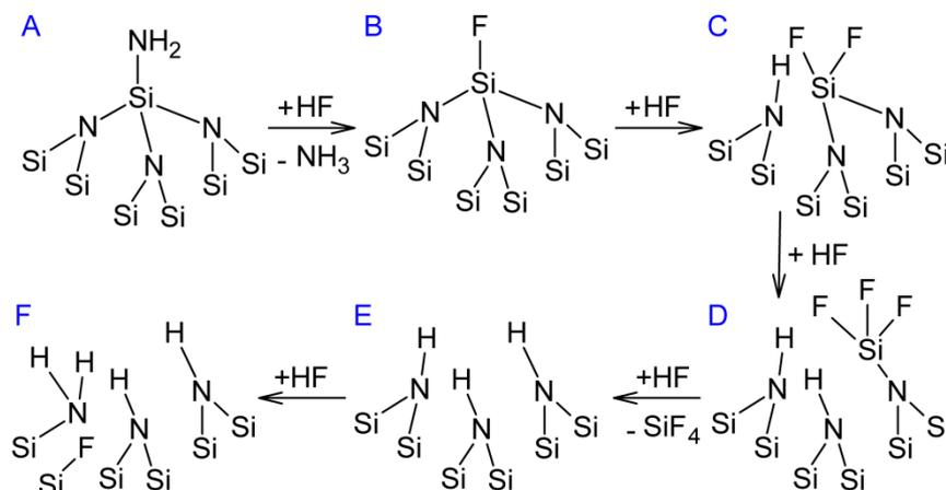
Figure 10 : Mécanisme du décapage du nitrure de silicium dans une solution d'acide fluorhydrique, adapté de Chabal et al. [6] : formation des liaisons Si-NH<sub>2</sub> et Si-F.
