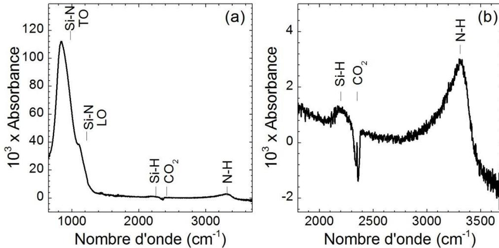
Figure 7 : Spectre infrarouge en transmission d'une surface de  $\text{Si}_{3,4}\text{N}_4$  : de 650 à 3700  $\text{cm}^{-1}$  (a) et zone des bandes d'absorption des vibrations Si-H et N-H de 1800 à 3700  $\text{cm}^{-1}$ . La référence est le *wafers* de silicium sur lequel la couche de  $\text{Si}_{3,4}\text{N}_4$  a été déposée.
