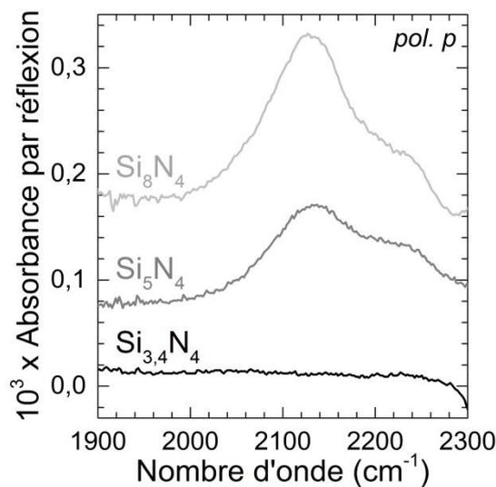
Figure 45 : Spectres infrarouges, en géométrie ATR, en polarisation  $p$ , de  $1850$  à  $2300 \text{ cm}^{-1}$  (zone des Si-H) de surfaces de nitrure de silicium  $\text{Si}_x\text{N}_4$  avec différents enrichissements en silicium :  $3,4 < x < 8$ , décapée 30 s dans une solution de HF 2 %. La surface de référence est la même surface avant décapage.
