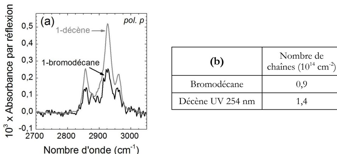
Figure 68 : (a) Spectres infrarouges, en mode ATR, en polarisation  $p$ , d'une surface de nitrure de silicium  $\text{Si}_{3,4}\text{N}_4$  greffée avec du 1-décène sous activation photochimique 254 nm (gris) ou avec du 1-bromodécane ( $110^\circ\text{C}$ ) pendant 24 h. La surface de référence est celle après décapage (b). Les valeurs correspondantes pour le rapport  $2 N_{\perp}/N_{\parallel}$  et la densité de chaînes greffées.
