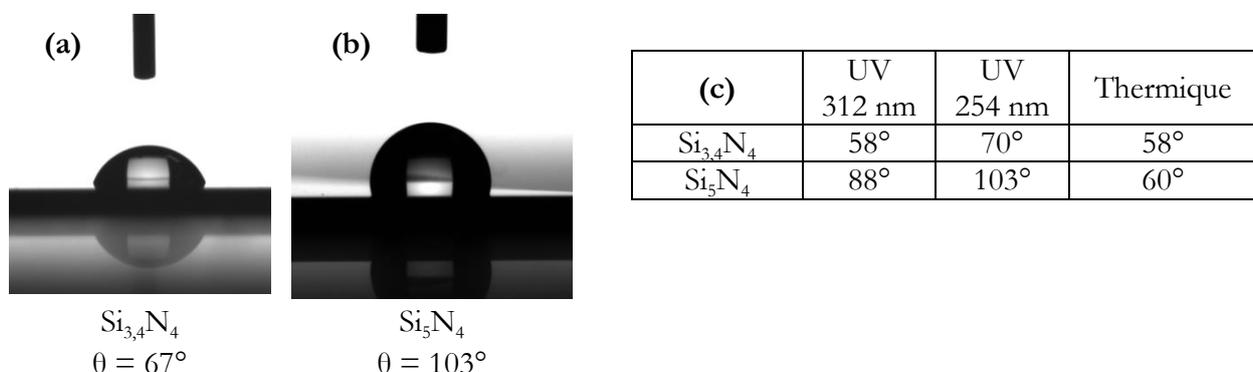
Figure 60 : Angles de contact d'une surface de nitrure de silicium  $\text{Si}_{3,4}\text{N}_4$  (a) ou  $\text{Si}_5\text{N}_4$  (b) fonctionnalisée 24 h avec le 1-décène avec activation UV 254 nm, 312 nm ou thermique (c).
