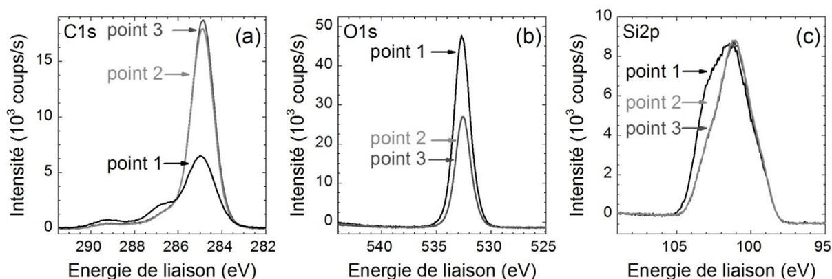
Figure 80 : Spectres XPS dans la zone C1s (a), O1s (b) et Si2p (c) en trois points différents (points 1, 2 et 3) d'une surface de  $\text{Si}_3\text{N}_4$  fonctionnalisée avec le 1-décène sous irradiation UV (24 h, 254 nm) et laissée à l'air ambiant pendant un an.
