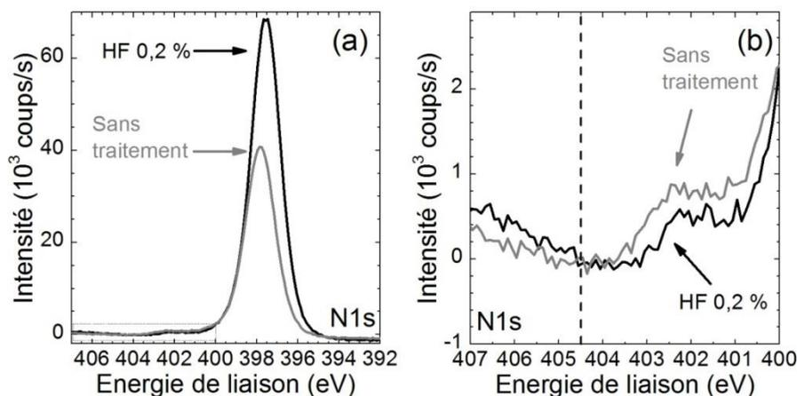
Figure 22 : Spectres XPS dans la zone N1s d'une surface de Si<sub>3,4</sub>N<sub>4</sub>, sans traitement et après 30 s de décapage dans une solution de HF 0,2 % de 407 à 392 eV (a) et de 407 à 400 eV (b). L'énergie des pics a été décalée en fixant l'énergie du pic du carbone C1s à 285,0 eV.
