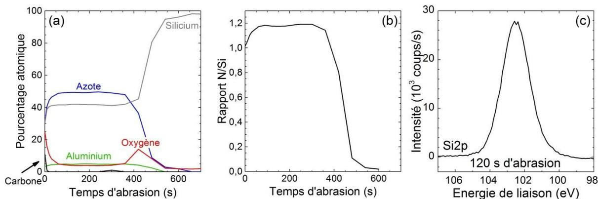
Figure 6 : Profil de composition XPS (a), rapport N/Si (b) et spectre XPS de la zone Si2p après 120 s d'abrasion ionique argon (c) de la couche de nitrure de silicium  $\text{Si}_x\text{N}_4$  déposée sur *wafers* de silicium, sans aucun traitement préalable. L'énergie des pics a été décalée en fixant l'énergie du pic du carbone C1s à 285,0 eV.
