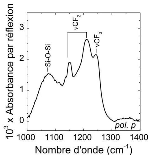
Figure 84 : Spectre infrarouge (ATR), en polarisation p, d'une surface de  $\text{Si}_3\text{N}_4$  riche en silicium décapée dans une solution de HF puis modifiée thermiquement (16 h,  $230^\circ\text{C}$ ) par le 1H, 1H, 2H-perfluoro-1-décène de  $1000$  à  $1400\text{ cm}^{-1}$ . Le spectre de référence est celui de la même surface après décapage et avant fonctionnalisation.
