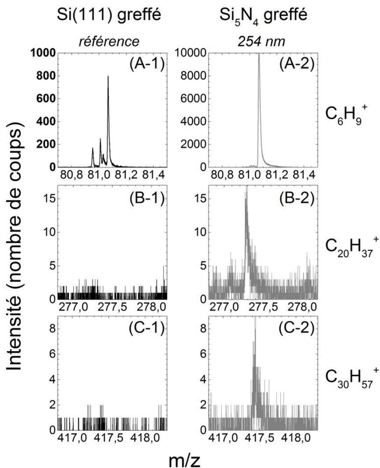
Figure 76 : Spectres de masse en mode positif (ToF-SIMS) associés aux fragments ioniques  $\text{C}_6\text{H}_9^+$  (A),  $\text{C}_{20}\text{H}_{37}^+$  (B),  $\text{C}_{30}\text{H}_{57}^+$  (C), pour une surface de Si(111) (1) et de  $\text{Si}_5\text{N}_4$  (2) fonctionnalisée avec le 1-décène sous irradiation UV 312 nm, 3 h pour le Si(111) et 254 nm, 24 h pour le  $\text{Si}_5\text{N}_4$ . Ces mesures ont été effectuées sur plusieurs échantillons, les mêmes fragments ont été observés.
