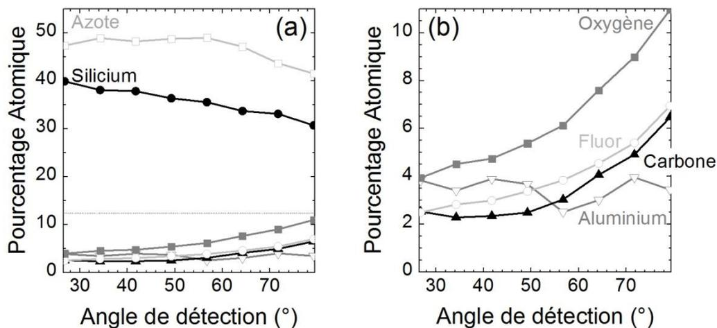
Figure 23 : Evolution des pourcentages atomiques déduits des mesures d'AR-XPS des différents éléments de la couche : azote et silicium (a) et oxygène, fluor, carbone et aluminium (b) en fonction de l'angle de détection des photoélectrons par rapport à la normale à la surface.
