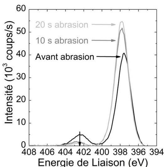
Figure 42 : Spectres XPS dans la zone N1s d'une surface de nitrure de silicium Si<sub>3,2</sub>N<sub>4</sub>, sans traitement préalable (noir) et après 10 s et 20 s d'abrasion ionique argon monoatomique (gris). L'énergie des pics a été été décalée en fixant l'énergie du pic du carbone à 285,0 eV.
