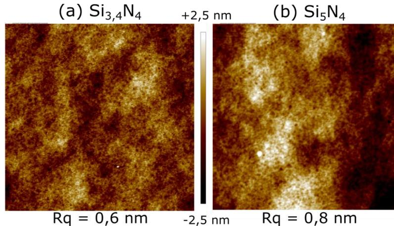
Figure 44 : Images AFM ( $5 \times 5 \mu\text{m}^2$ ) d'une surface de nitrure de silicium  $\text{Si}_{3,4}\text{N}_4$  non enrichi (a) et  $\text{Si}_5\text{N}_4$  enrichi (b) après un décapage dans une solution d'acide fluorhydrique 2 % 30 s.
