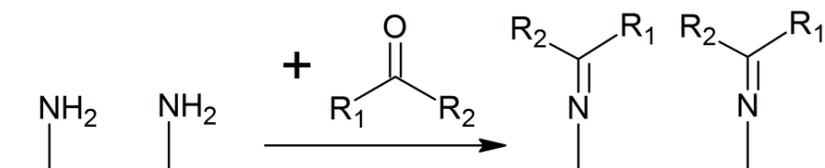
Figure 56 : Réaction entre les amines primaires de surface et un aldéhyde ou une cétone pour former une base de Schiff.
