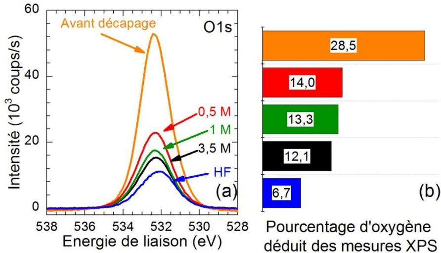
Figure 37 : Spectres XPS dans la zone O1s (a), ainsi que le pourcentage d'oxygène déduit des mesures XPS (b) d'une surface de  $\text{Si}_{3,4}\text{N}_4$  sans traitement, après décapage dans une solution de HF (30 s 0,2 %) ou de KOH à 80°C (0,5 M 30 s, 1 M 30 s ou 3,5 M 180 s). L'énergie des pics a été décalée en fixant l'énergie du pic du carbone C1s à 285,0 eV.
