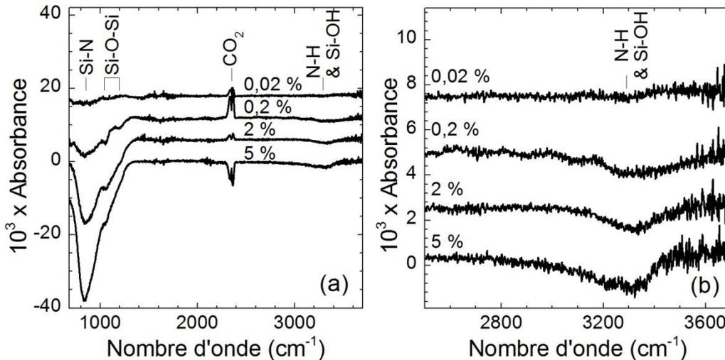
Figure 12 : Spectres infrarouges en transmission d'une surface de  $\text{Si}_{3,4}\text{N}_4$  décapée 30 s dans une solution de HF de différentes concentrations : de 700 à 3700  $\text{cm}^{-1}$  (a) et dans la zone de la bande d'absorption des vibrations N-H de 2500 à 3700  $\text{cm}^{-1}$  (b). La référence est la surface oxydée (nettoyée dans une solution de « piranha »). Les spectres sont décalés en absorbance pour faciliter la lecture.
