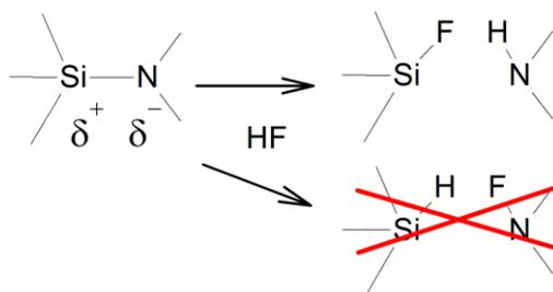
Figure 50 : Rupture de la liaison Si-N et formation des liaisons Si-F et N-H lors du décapage du nitrure de silicium dans une solution de HF.
