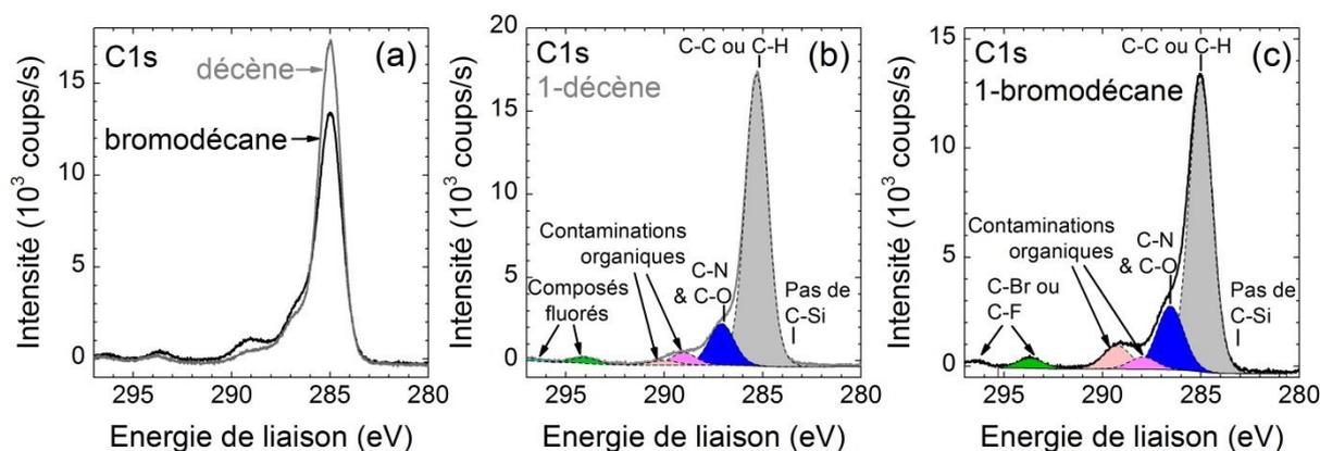
Figure 69 : Spectres XPS dans la zone C1s d'une surface de  $\text{Si}_{3,4}\text{N}_4$  fonctionnalisée avec le 1-décène sous irradiation UV (254 nm, 24 h) ou avec le 1-bromodécane ( $110^\circ\text{C}$ , 24 h) (a) et leurs reconstructions pour le greffage du 1-décène (b) et du 1-bromodécane (c).
