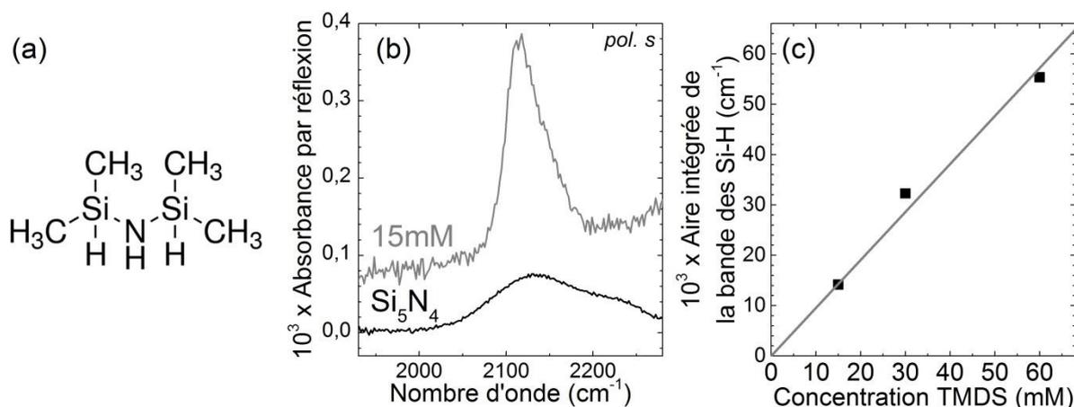
Figure 46 : Molécule de tétraméthylsilazane (TMDS) (a). Spectres infrarouges en mode ATR du TMDS dilué dans l'éthanol dans la zone des vibrations Si-H et surface de  $\text{Si}_5\text{N}_4$  décapée à l'acide fluorhydrique (2 % 30 s) (b). Courbe de calibration du tétraméthylsilazane à partir de l'aire intégrée du pic de 1980 à 2280  $\text{cm}^{-1}$  par réflexion (c).
