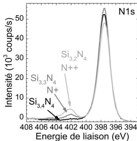
Figure 41 : Spectres XPS dans la zone N1s de surfaces de nitrure de silicium  $\text{Si}_x\text{N}_4$ , après un décapage dans une solution de HF (0,2 %, 30 s), le nitrure de silicium  $\text{Si}_x\text{N}_4$  présente différents enrichissements en azote correspondant à  $3,2 < x < 3,4$ . L'énergie des pics a été décalée en fixant l'énergie du pic du carbone C1s à 285,0 eV.
