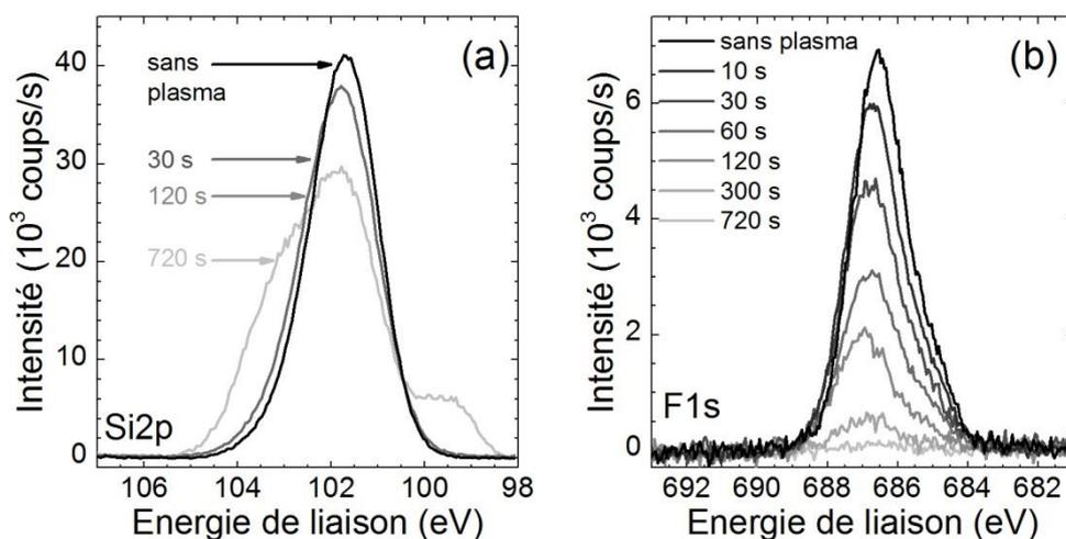
Figure 48 : Spectres XPS dans la zone du pic Si2p (a) et F1s (b) d'une surface de  $\text{Si}_{3,4}\text{N}_4$  décapée au HF (0,2 % 30 s) (noir), puis traitée avec un plasma d'hydrogène pendant 10 s, 30 s, 60 s, 300 s et 720 s.
