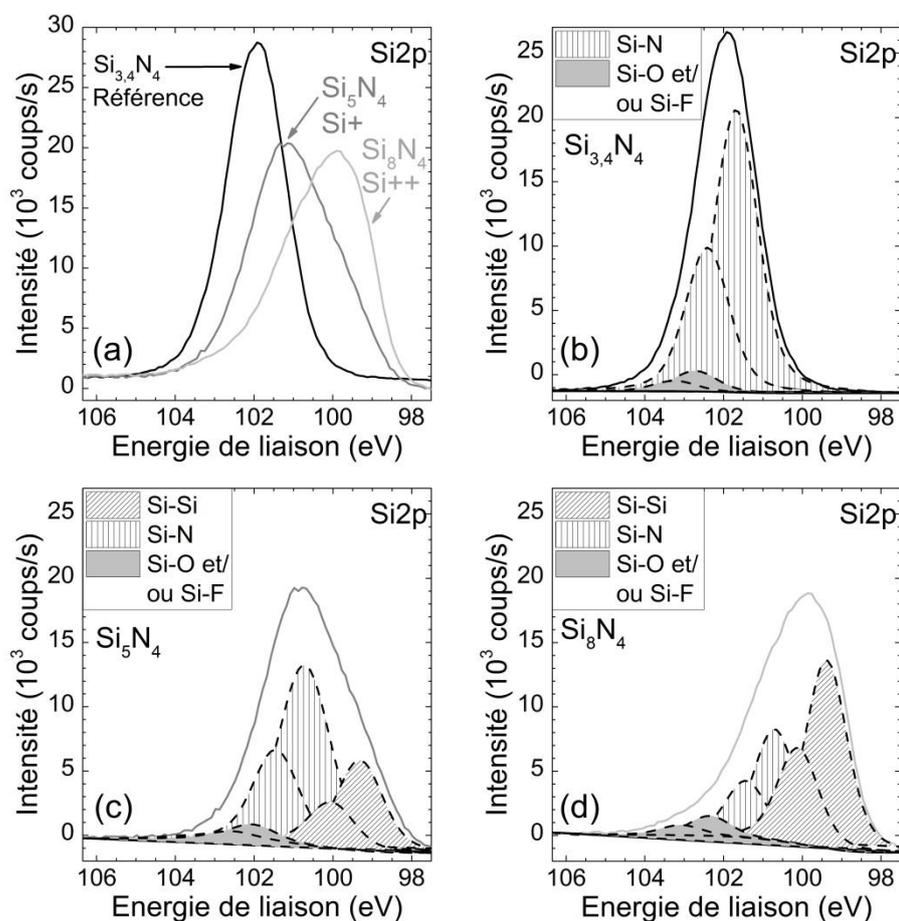
Figure 43 : Spectres XPS dans la zone Si2p de surfaces de nitrure de silicium  $\text{Si}_x\text{N}_4$  avec différents enrichissements en silicium :  $3,4 < x < 8$ , décapée dans une solution de HF (2 % 30 s) (a) et leurs reconstructions  $x = 3,4$  (b),  $x = 5 - \text{Si}^+$  (c) et  $x = 8 - \text{Si}^{++}$  (d). L'énergie des pics a été décalée en fixant l'énergie du pic du carbone C1s à 285,0 eV.
