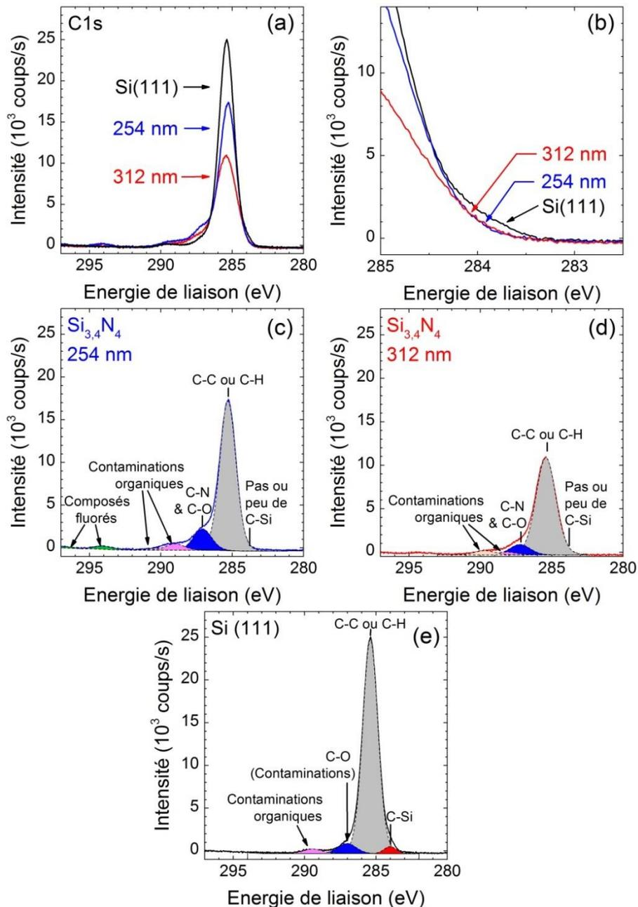
Figure 63 : Spectres XPS dans la zone C1s de surfaces de  $\text{Si}_{3,4}\text{N}_4$  et de Si(111) fonctionnalisées avec le 1-décène sous irradiation 312 nm & 254 nm, 24 h pour le  $\text{Si}_{3,4}\text{N}_4$  et 312 nm, 3 h pour le Si(111) (a) & (b), et leurs reconstructions pour la surface de  $\text{Si}_{3,4}\text{N}_4$  254 nm (c), 312 nm (d) et de Si(111) (e).
