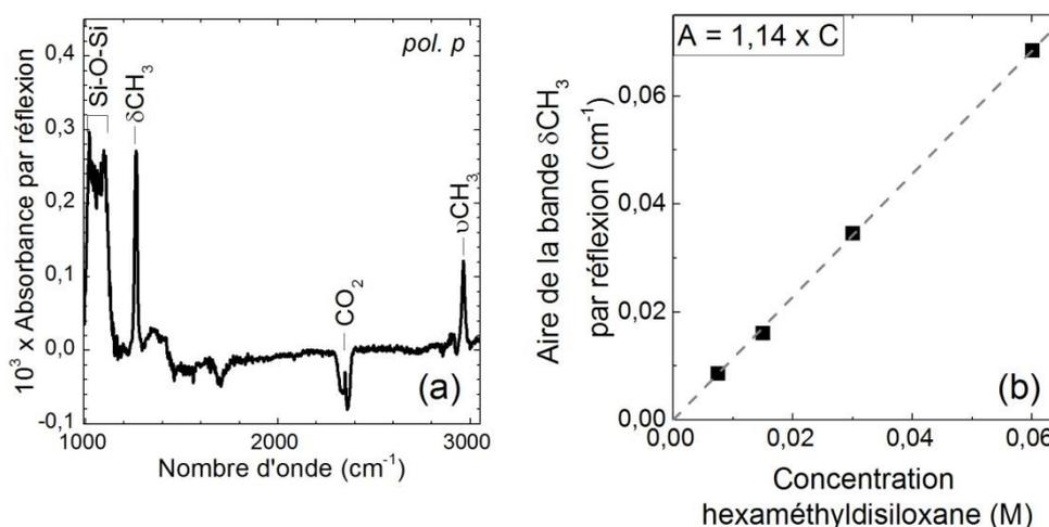
Figure 28 : Spectre infrarouge, en géométrie ATR, en polarisation p, de 980 à 3080 cm<sup>-1</sup> d’une surface de Si<sub>3,4</sub>N<sub>4</sub>, décapée dans une solution de HF 2 % 30 s après réaction avec l’HMDS. La surface de référence est la même surface avant exposition à l’HMDS (a) et courbe de calibration de l’hexaméthylsiloxane (b).
