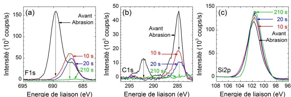
Figure 86 : Spectres XPS dans la zone F1s (a), C1s (b) et Si2p (c), d'une surface de Si<sub>5</sub>N<sub>4</sub> fonctionnalisée par le 1H, 1H, 2H-perfluoro-1-décène (16 h, 230°C), avant et après 10 s, 20 s et 210 s d'abrasion avec un faisceau d'argon monoatomique.
