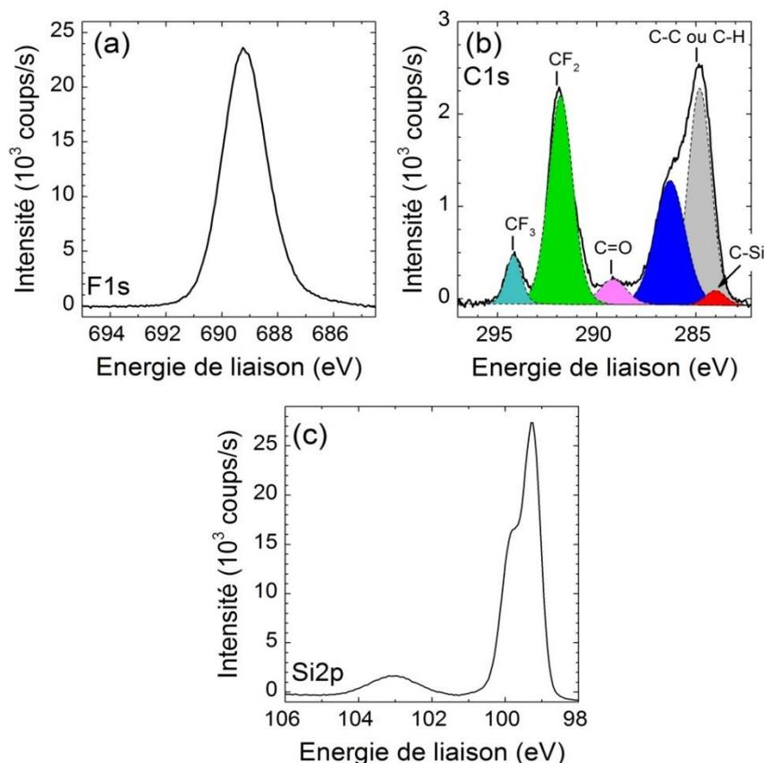
Figure 83 : Spectres XPS dans la zone F1s (a), C1s (b) et Si2p (c) d'une surface de Si(111) fonctionnalisée avec le 1H, 1H, 2H-perfluoro-1-décène par traitement thermique 16 h, 230°C.
