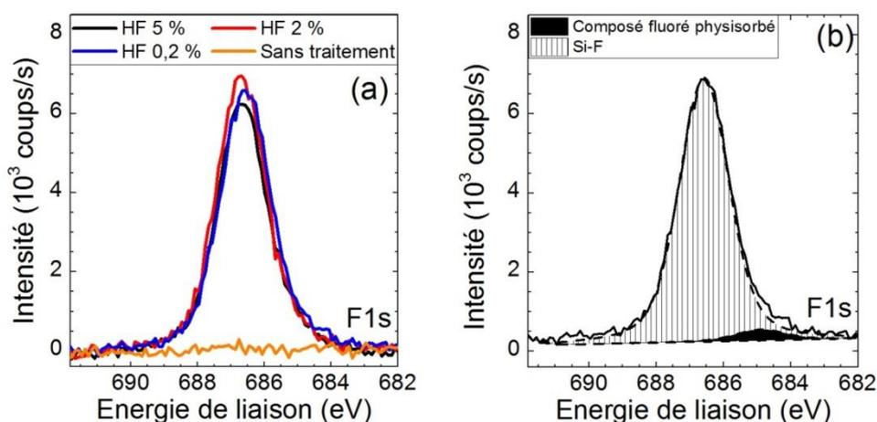
Figure 21 : Spectres XPS dans la zone F1s d'une surface de Si<sub>3,4</sub>N<sub>4</sub>, sans traitement et après décapage dans une solution de HF 30 s de différentes concentrations (0,2 % à 5 %) (a) et les reconstructions après décapage HF 0,2 % (b). L'énergie des pics a été décalée en fixant l'énergie du pic du carbone C1s à 285,0 eV.
