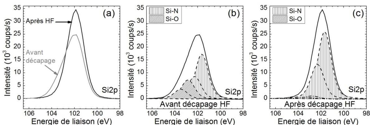
Figure 14 : Spectres XPS dans la zone Si2p d'une surface de  $\text{Si}_{3,4}\text{N}_4$ , nettoyée dans une solution de « piranha » avant et après décapage dans une solution de HF (0,2 % 30 s) (a) et leurs reconstructions avant décapage (b) et après décapage (c). L'énergie des pics a été décalée en fixant l'énergie du pic du carbone C1s à 285,0 eV.
