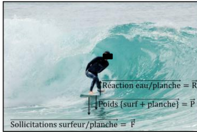
Figure 30 : Sollicitations mécaniques extérieures s'exerçant sur une planche
