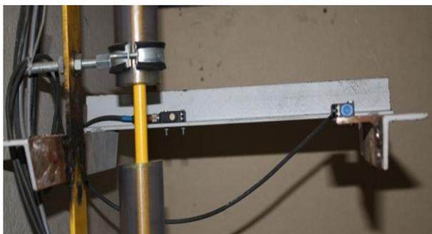
Figure A.5: Capteurs Ultrason, Mesure du Déplacement Latéral
