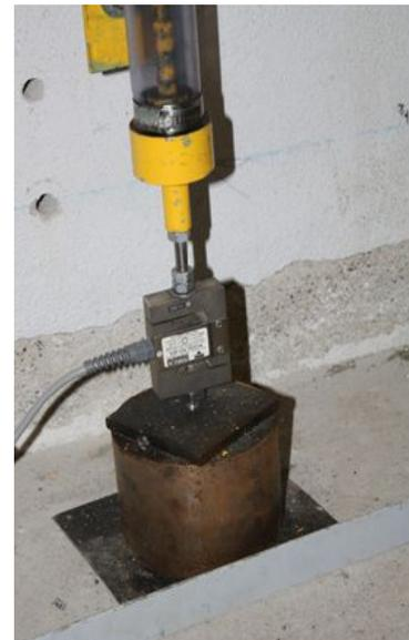
Figure A.4: Capteur de Force, Mesure de la Force de Compression
