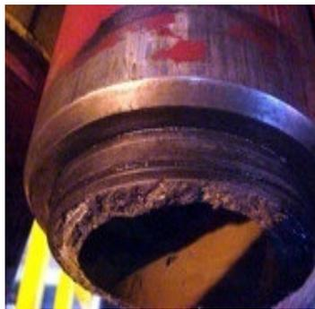
**Figure 1.9: Rupture d'une Tige de Forage**
