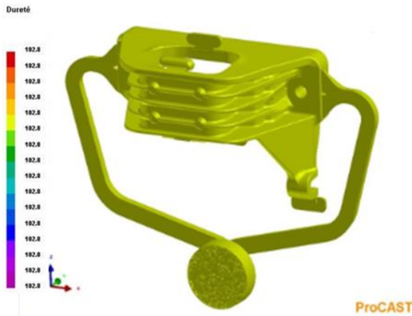
Figure 94: Cartographie de la dureté (HBw) de l'alliage 3
