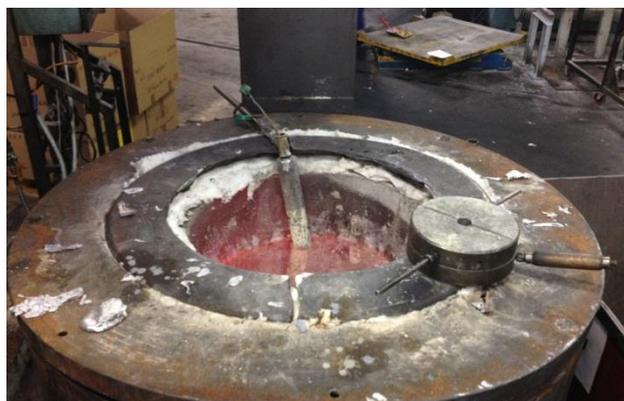
Figure 28 : Four de maintien utilisé lors des coulées
