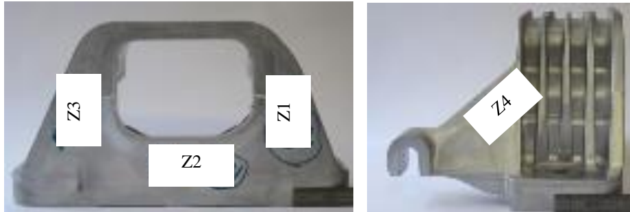
Figure 31: Zones de prélèvement des éprouvettes de caractérisation
